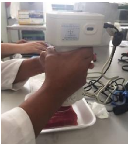
Figura 11. Colorímetro Konica Minolta CM-600d
