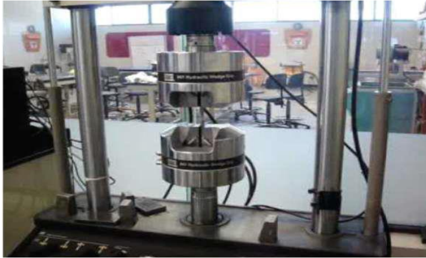
Figura 36. Prueba de tensión establecida en la NMX-C-407.
