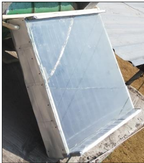
Figura 26. Cubierta de vidrio reciclado reconstruido y sellado con silicón. Fuente elaboración propia.
