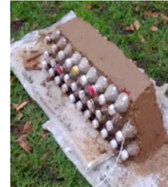
Imagen 21.0 Muestra de desplante de muros a base de pet.
