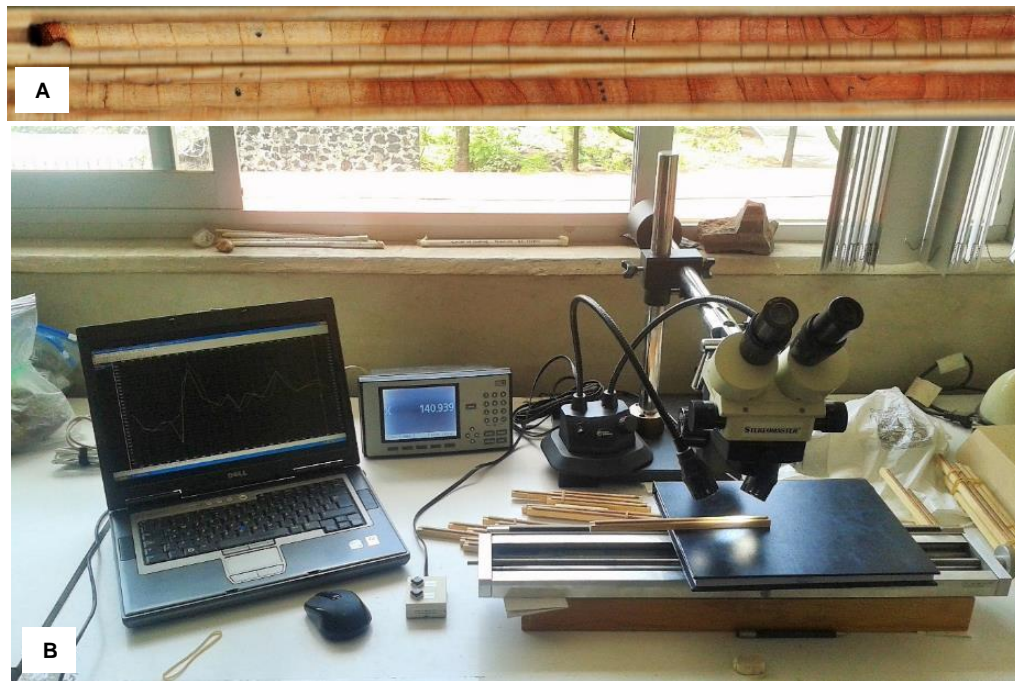
Figura 22. (A) Montado de series de crecimiento de Juniperus deppeana y (B) el sistema de medición VELMEX.
