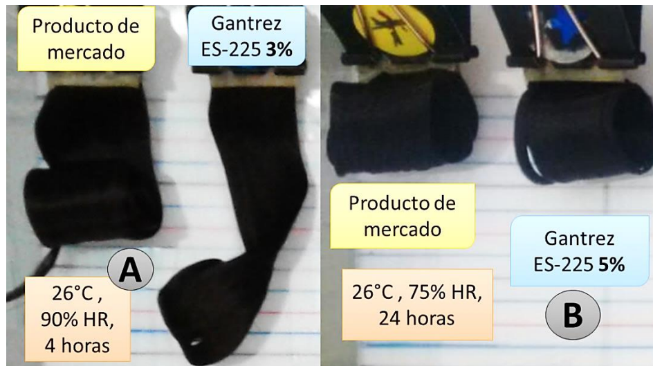
Figura 41. Pruebas de retención de rizo a diferentes condiciones. A) Durante 240 minutos a 26°C y 90% Humedad Relativa (tabla 24). B) Por 1440 minutos a 26°C y 75% Humedad Relativa (tabla 25).
