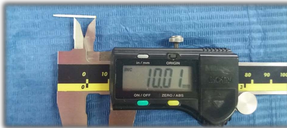
Figura 12. Toma del punto medio en un poste Reforpost Ángelus® fabricados en Brasil fuente directa .
