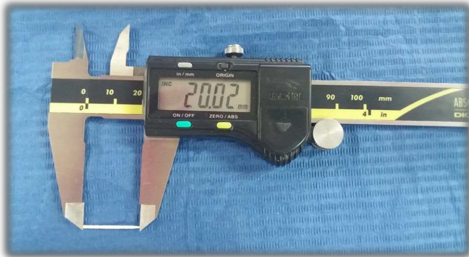
Figura 11. Toma de la longitud total en un poste Reforpost Ángelus® fabricados en Brasil fuente directa .
