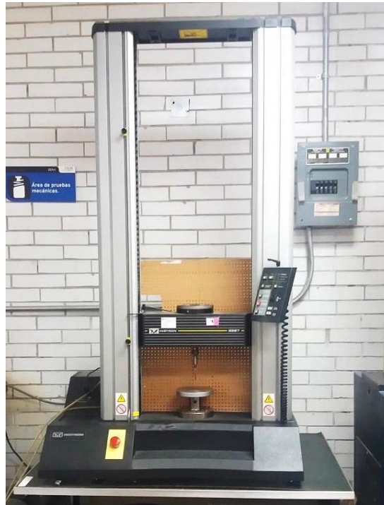
Figura 7. Máquina Universal de pruebas mecánicas Instron modelo 5567 USA fuente directa .
