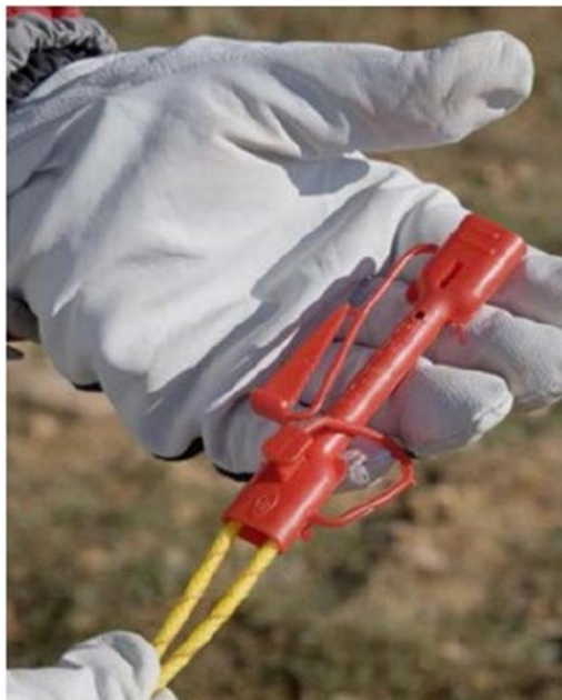
Figura 9 Relé de micro-retardo. Bernaola, Castillas y Herrera, 2013, p. 123.
