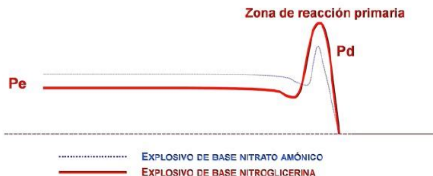
Figura 3 Presión de detonación ( P_d ) y presión de burbuja P_e . Bernaola, et al, 2013, p. 69.
