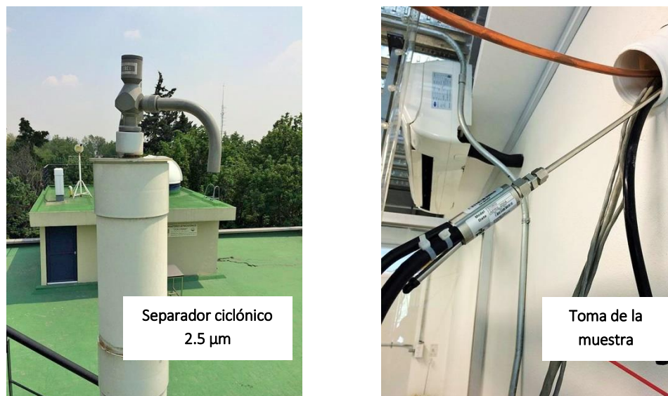
Figura 11. Montaje experimental para la medición de las distribuciones de tamaño. Incluye un separador ciclónico de 2.5 \mu\text{m} y la toma de muestra.
