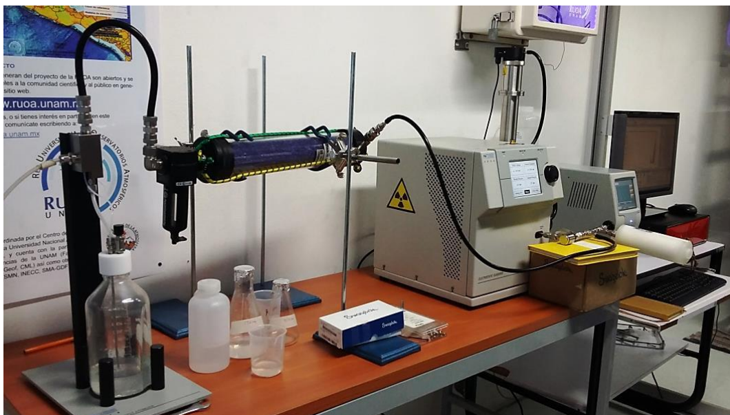
Figura 16. Montaje experimental para la verificación de la calibración del DMA: Generador de Aerosoles (nebulizador), Secador, Clasificador Electrostático y Contador de Partículas de Condensación.
