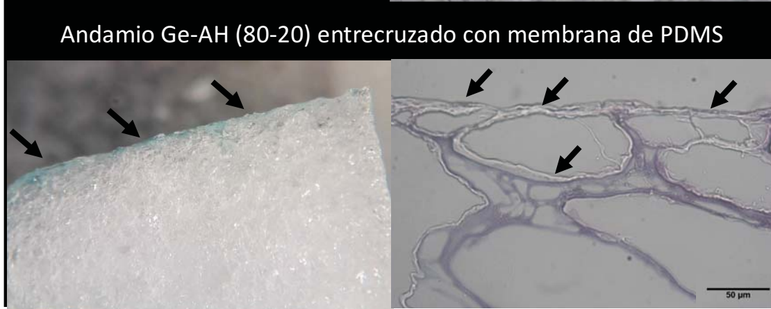
Figura 5. Andamios de Ge-AH a diferentes proporciones entrecruzados, con y sin la membrana de PDMS.
