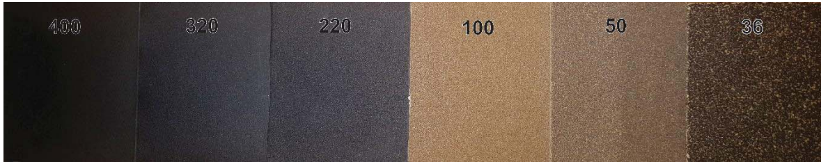
Figura 31. Tipos de lijas utilizados para el proceso de pulimiento. La primera lija utilizada es la de mayor grosor de grano, grado 36, hasta llegar al grado 400 que es el grano más fino. Al disminuir el tamaño de grano de las lijas, se consigue un grado de pulimiento que permite apreciar de forma adecuada los anillos de crecimiento de las muestras.
