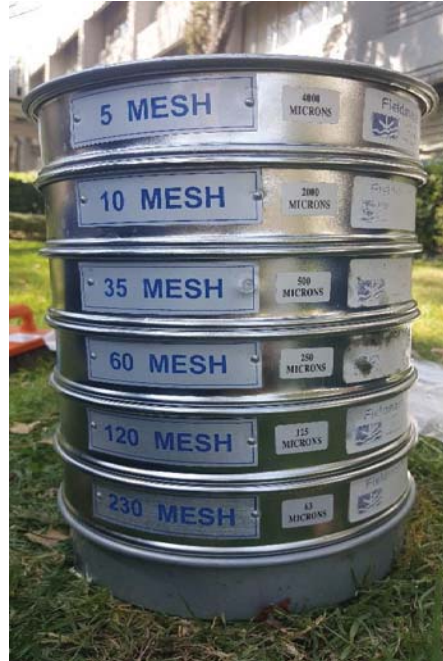
Figura 36. Juego de tamices superpuestos en orden descendente (tamaño de malla) 4000\ \mu - 63\ \mu .
