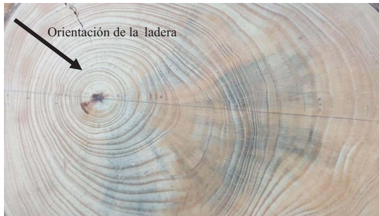
Figura 6. Muestra de Pinus leiophylla inclinado, en la cual se puede observar la excentricidad de los anillos de crecimiento.
