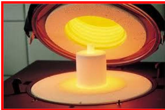
Imagen 29. Proceso de cerámicas termo prensadas
