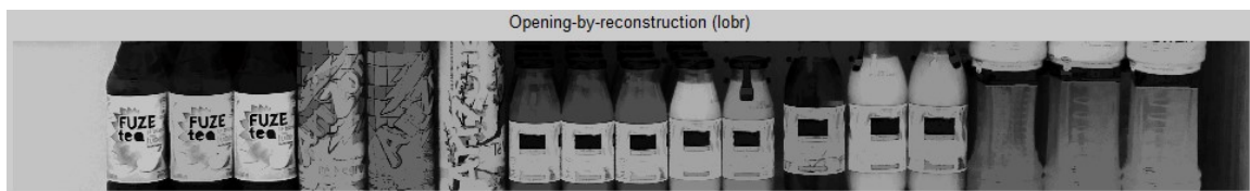
Figura 18 Imagen de repisa tras aplicar apertura por reconstrucción
