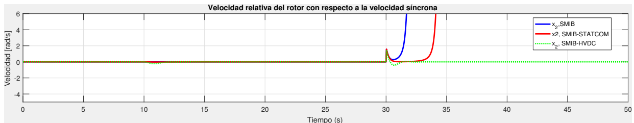
Figura 4.8: Velocidad relativa \omega para los sistemas: SMIB, SMIB-STATCOM y SMIB-HVDC, tiempo de liberación de falla t = 36ms
