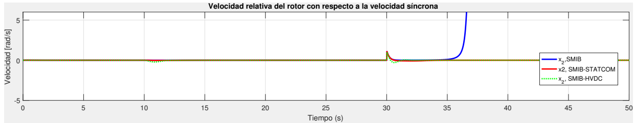
Figura 4.7: Velocidad relativa \omega para los sistemas: SMIB, SMIB-STATCOM y SMIB-HVDC, tiempo de liberación de falla t = 24ms
