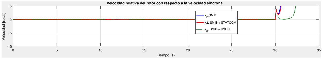
Figura 4.9: Velocidad relativa \omega para los sistemas: SMIB, SMIB-STATCOM y SMIB-HVDC, tiempo de liberación de falla t = 98ms
