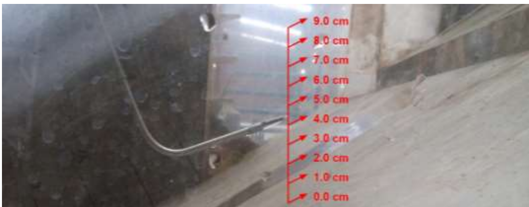
Figura 3.21. Alturas a las que se registraron datos con la sonda
