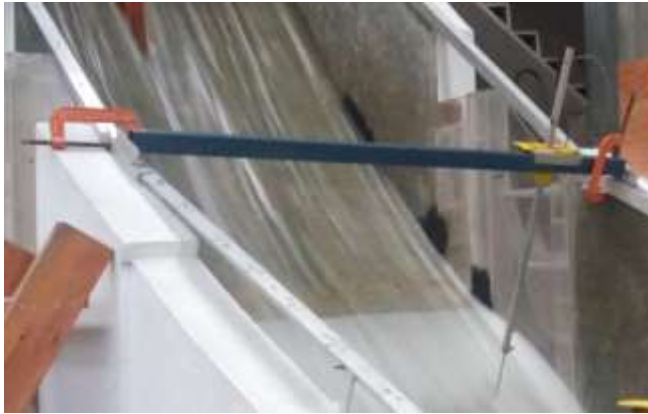
Figura 3.27a. Sonda colocada sobre el aireador.
