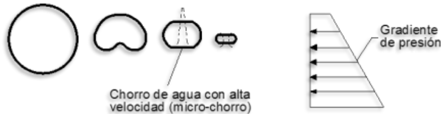
Figura 2.6. Colapso de una burbuja en presencia de un gradiente de presión.
