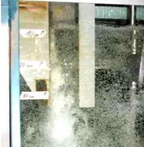
Figura 1.24. Entrada de aire por chorro en soporte vertical causado por vórtices con ejes perpendiculares a la dirección del flujo (Foto: Chanson, 2002).
