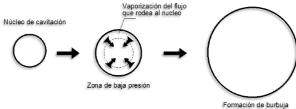
Figura 2.4. Expansión de un núcleo de cavitación.
