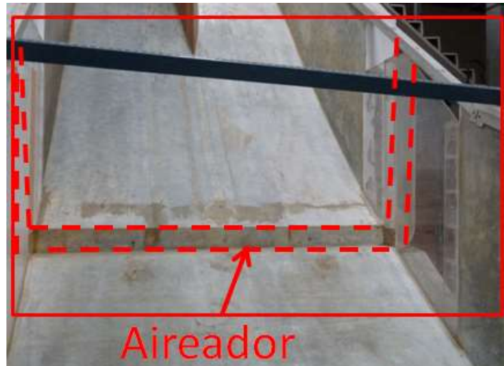
Figura 3.13 Aireador del modelo
