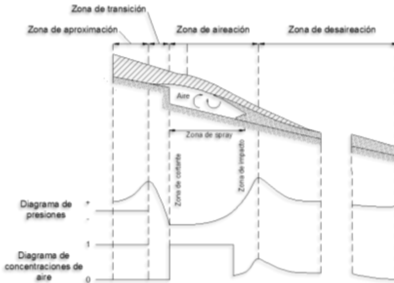
Figura 2.25. Regiones de flujo para un aireador típico (modificado de Volkart y Rutschmann 1984)
