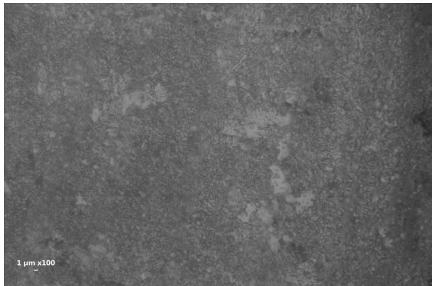
Figura 66 Microestructura del Cu Electrolytíco con ECAP .
