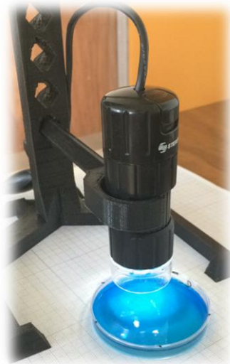
Figura 2. 39 Microscopio de campo con soporte, para observar biopolímero
