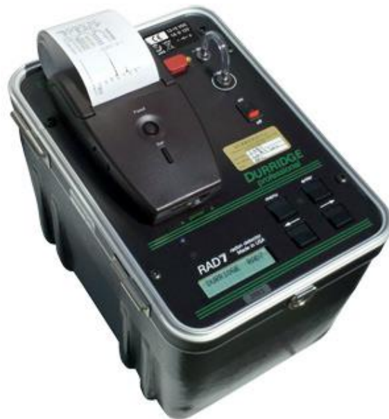
Figura 1. 13 Detector electrónico de Radón RAD7 (durrIDGE.com, 2017).
