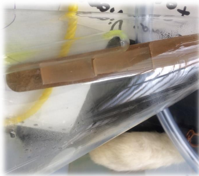
Figura 2. 16 Embudo de 1 L con biopolímero y mineral de Uranio.
