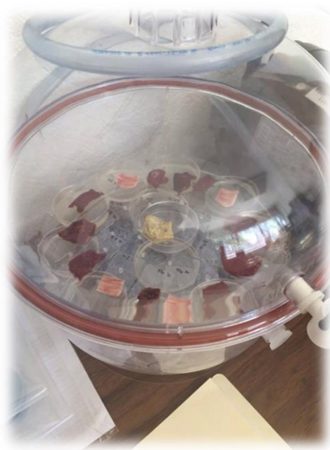
Figura 2. 27 Biopolímero y tejido en desecador con mineral de Uranio.
