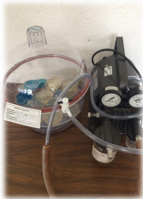
Figura 2. 23 Desecador conectado a bomba de vacío, con biopolímeros revelados (azules) y biopolímeros en exposición
