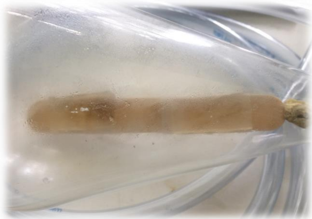
Figura 3. 5 Embudo con biopolímeros en abatelenguas y mineral de uranio
