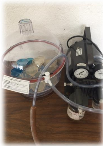
Figura 3. 6 Desecador conectado a bomba de vacío, con biopolímeros revelados (azules) y biopolímeros en exposición
