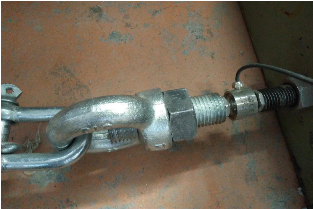
FIGURA 14 DETALLE CONEXIÓN SENSOR DE PRESIÓN. Ídem.
