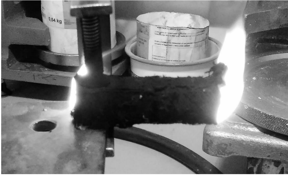
FIGURA 129 PROBETA D635 EXTINCIÓN DE LA LLAMA. Ídem.
