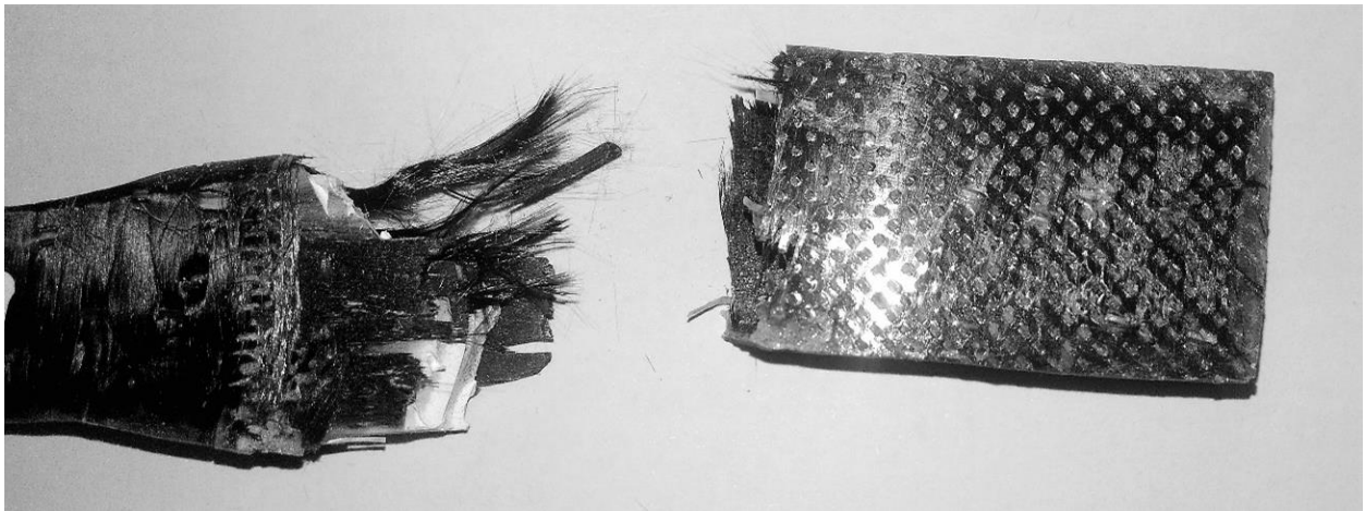
FIGURA 89 FRACTURA PROBETA LAMINADA POR CONFINAMIENTO A 20°- ADHERENCIA PARCIAL.
