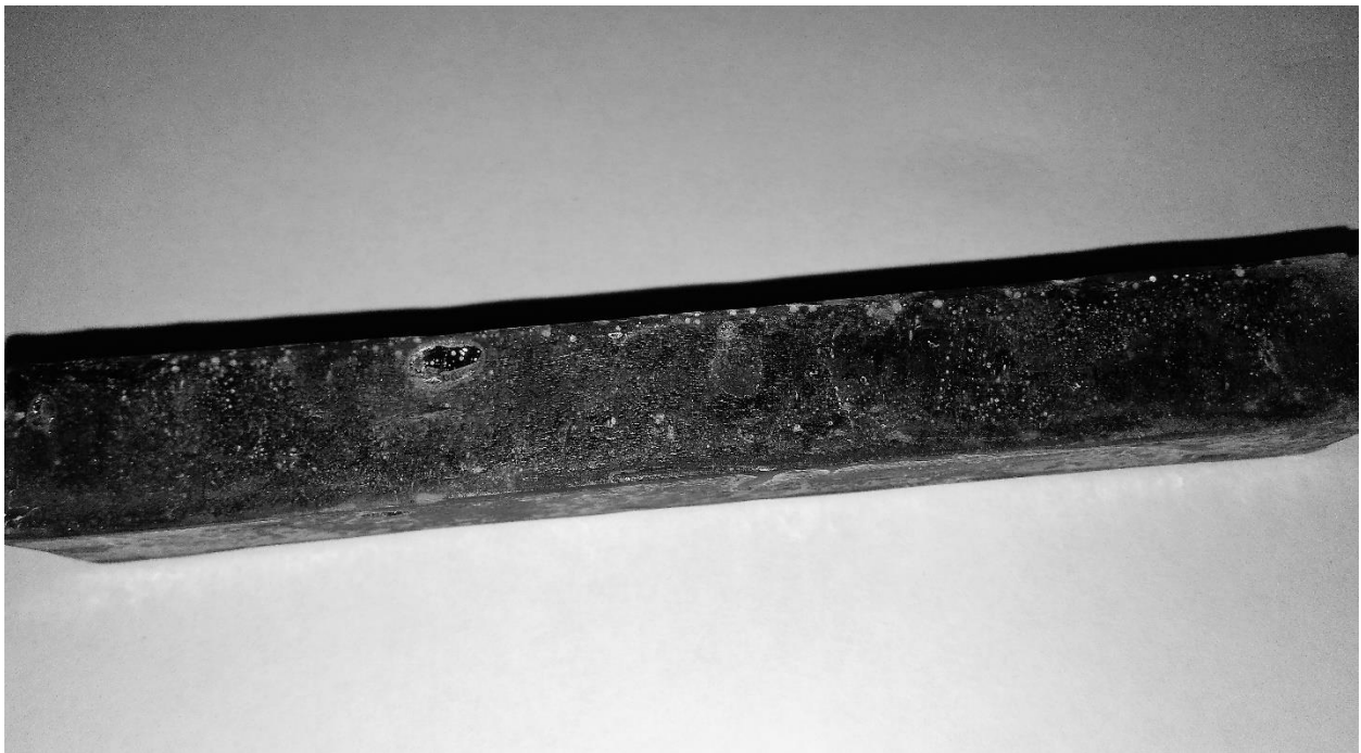
FIGURA 163 PROBETA D1435-01, ENVEJECIMIENTO A LA INTEMPERIE.
