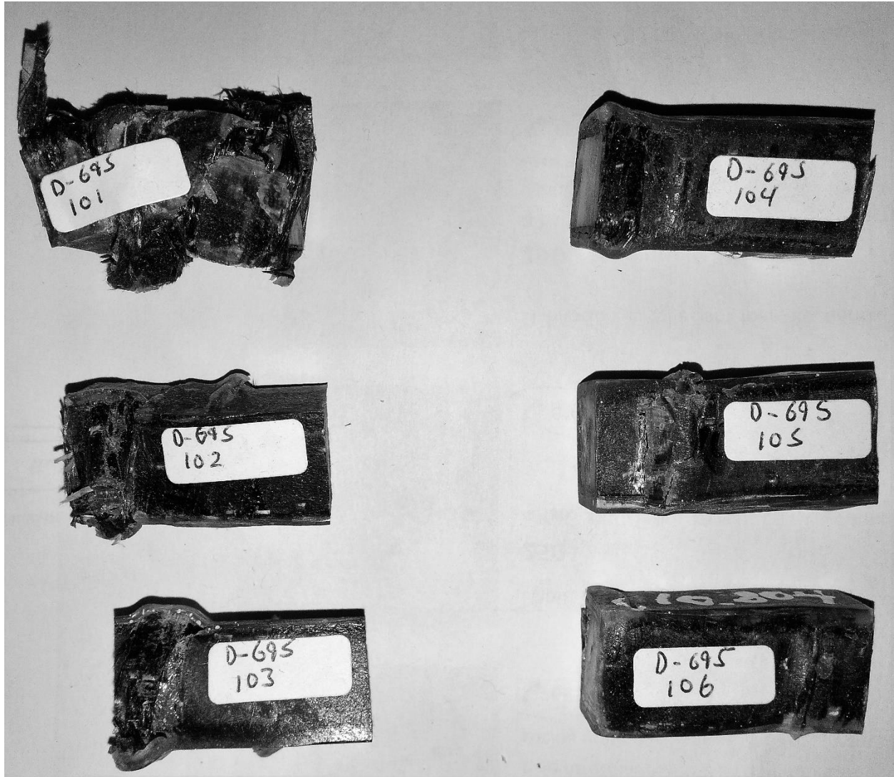
FIGURA 101 PROBETAS D695 CORTAS DESPUÉS DE LOS ENSAYOS.
