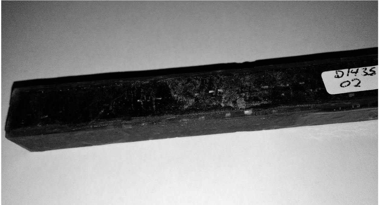
FIGURA 159 PROBETA D1435-02, ENVEJECIMIENTO A LA INTEMPERIE.
