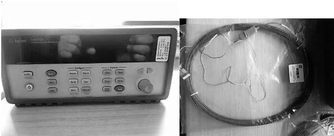
FIGURA 149 DATA LOGGER AGILENT Y TERMOPAR. Fotografía del equipo tomada con permiso del Laboratorio de Sustentabilidad y Energía, y la Universidad Nacional Autónoma de México (UNAM).
