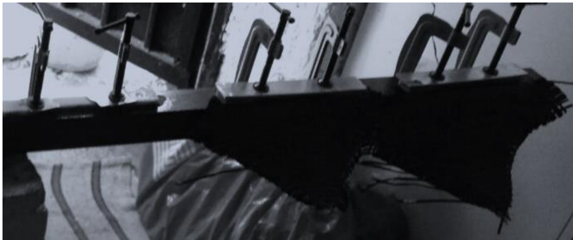
FIGURA 57 COLOCACIÓN DE LAMINADOS TIPO SÁNDWICH EN MOLDES METÁLICOS.
