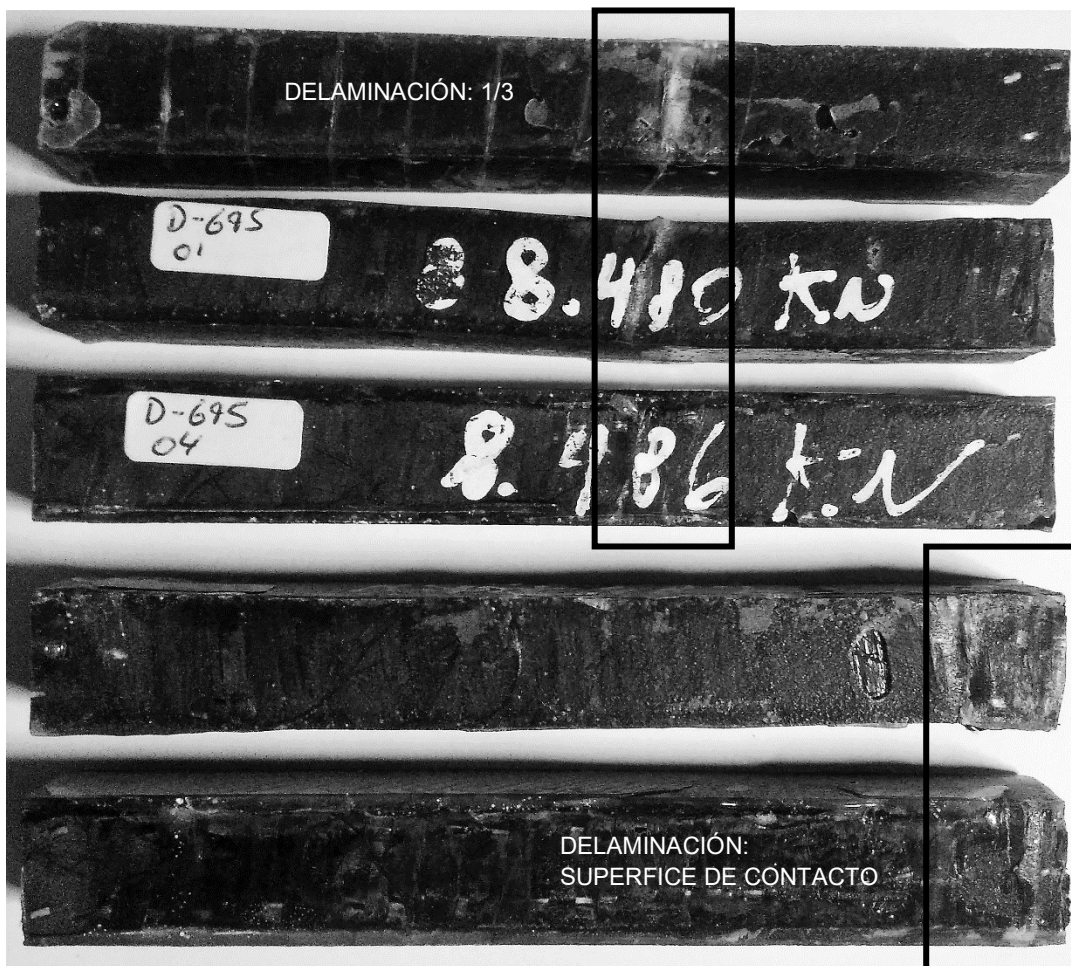
FIGURA 97 PROBETAS D 695 CON DEFORMACIONES POR PANDEO LOCAL.
