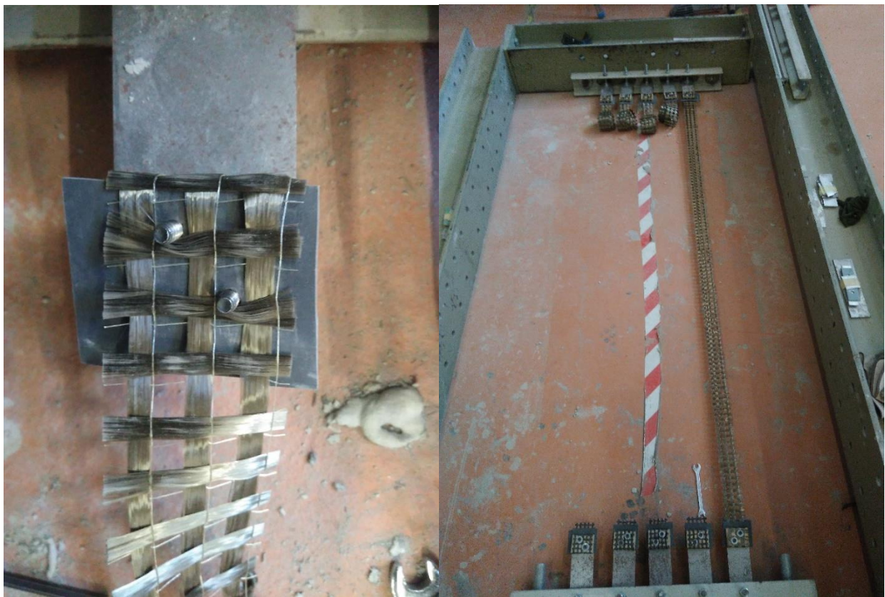
FIGURA 6 DETALLE DE MONTAJE FIBRA DE BASALTO EN ESTRUCTURA METÁLICA. Fotografía del equipo tomada con permiso del Laboratori per a la Innovació Tecnològica d'Estructures i Materials (LITEM) y la Universidad Politécnica de Cataluña (UPC).
