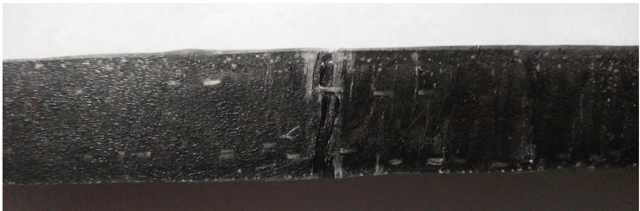
FIGURA 120 PROBETA D790-03 FRACTURA FRÁGIL (PARED HORIZONTAL).
