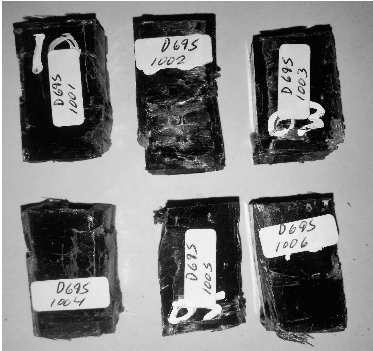
FIGURA 175 PROBETAS D695 SIN NÚCLEO DESPUÉS DE ENSAYO DE COMPRESIÓN.
