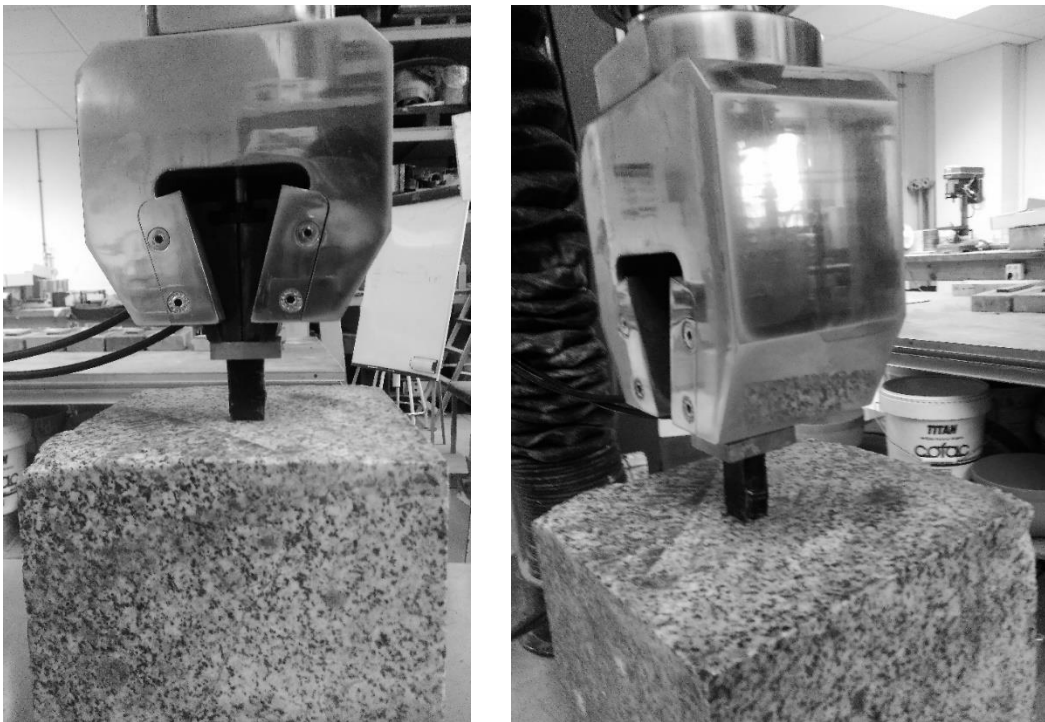
FIGURA 174 MONTAJE PROBETA SIN NÚCLEO DE ABS. Fotografía del equipo tomada con permiso del Laboratori per a la Innovació Tecnològica d'Estructures i Materials (LITEM) y la Universidad Politécnica de Cataluña (UPC).
