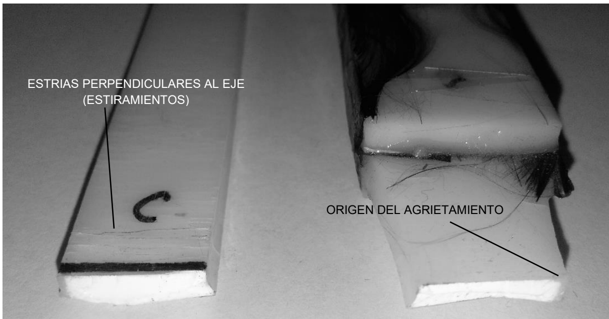
FIGURA 141 DETALLE FRACTURA PROBETA D3163-C.
