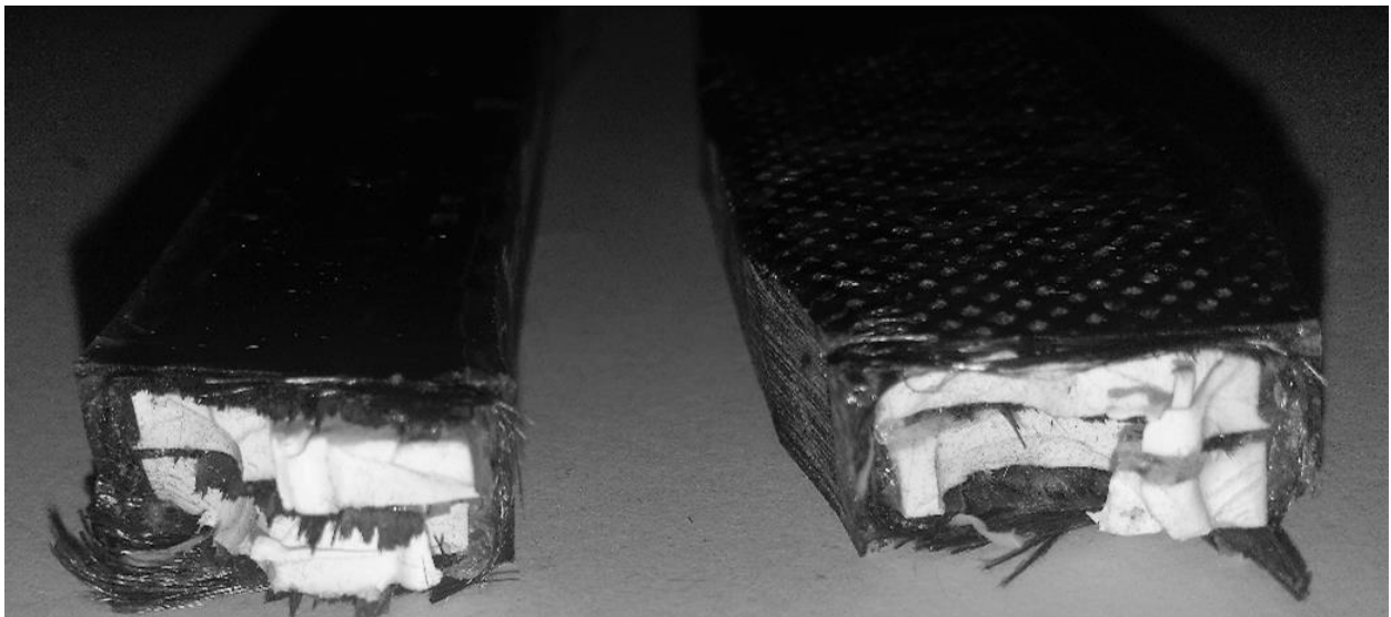
FIGURA 90 FRACTURA PROBETA LAMINADA POR CONFINAMIENTO A 20°- ADHERENCIA HOMOGÉNEA.
