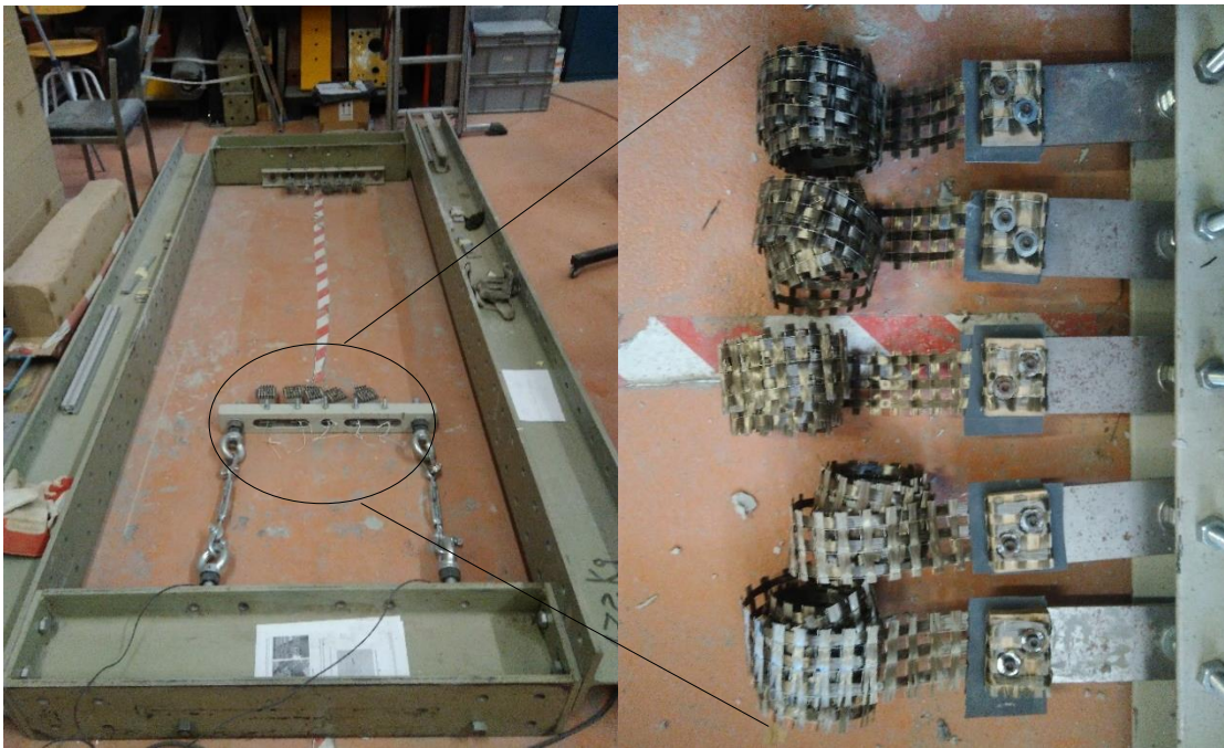
FIGURA 5 ESTRUCTURA PARA TENSAR Y DETALLE MONTAJE FIBRA DE BASALTO. Ídem.
