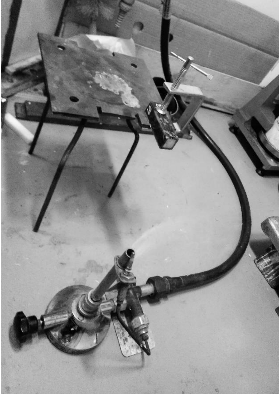
FIGURA 124 PROBETA D635-01 MONTADA PARA ENSAYO DE INFLAMABILIDAD. Fotografía del equipo tomada con permiso del Laboratori per a la Innovació Tecnològica d'Estructures i Materials (LITEM) y la Universidad Politècnica de Catalunya (UPC).
