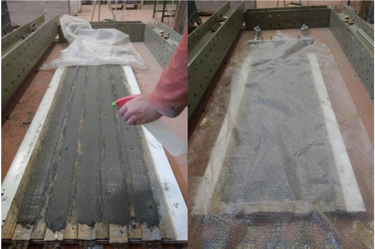
FIGURA 23 CURADO DE PROBETAS DE MORTERO Y PROTECCIÓN. Ídem.
