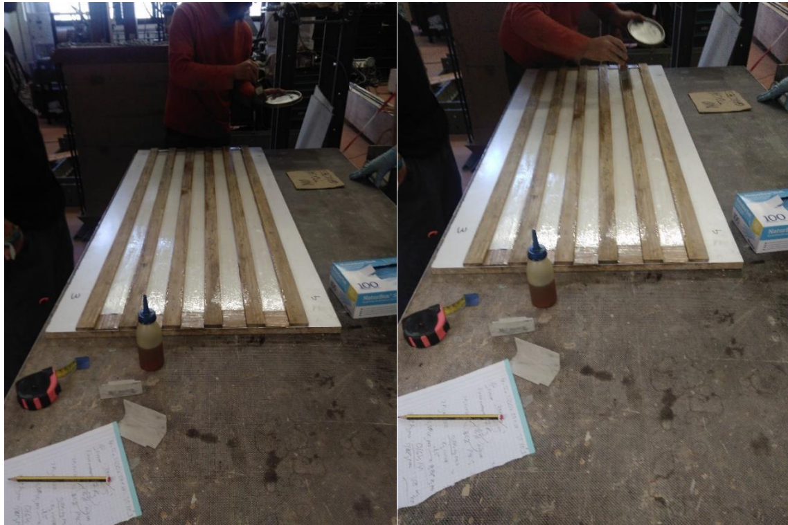
FIGURA 17 CURADO DE MOLDES PARA PROBETAS DE MORTERO REFORZADO CON FIBRAS DE BASALTO. Ídem.
