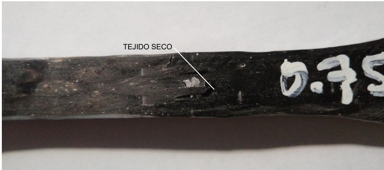
FIGURA 112 PROBETA D790-05, DETALLE DE FRACTURA FRÁGIL.
