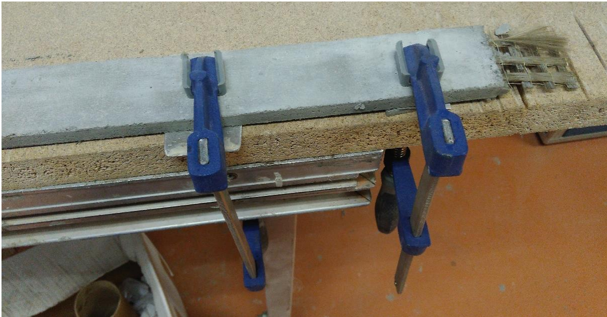
FIGURA 26 PROBETA DE MORTERO REFORZADO PREPARADA PARA CORTE. Ídem.
