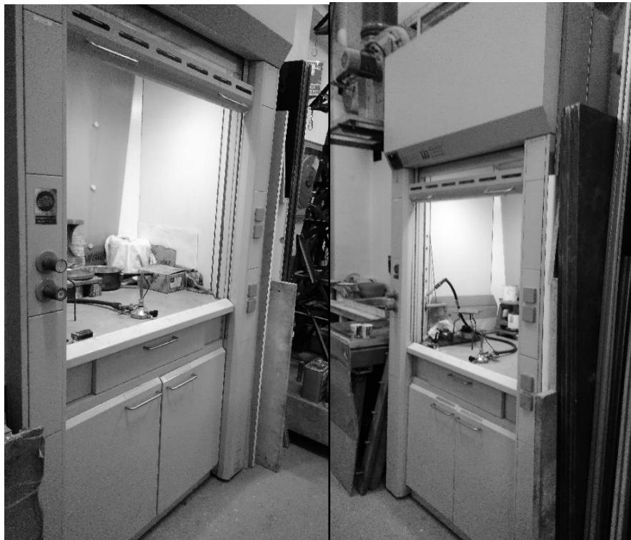
FIGURA 121 CÁMARA DE PRUEBAS DE COMBUSTIÓN HORIZONTAL Y VERTICAL. Fotografía del equipo tomada con permiso del Laboratori per a la Innovació Tecnològica d'Estructures i Materials (LITEM) y la Universidad Politècnica de Catalunya (UPC).
