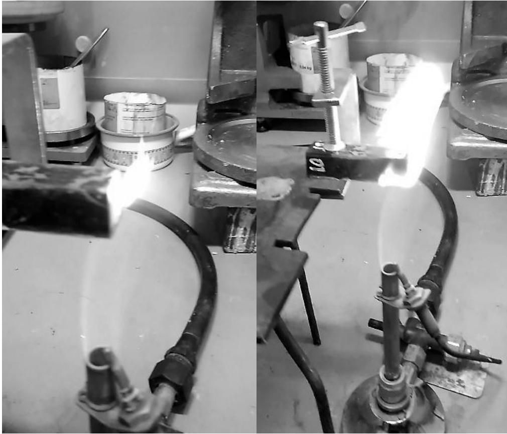
FIGURA 125 PROBETA D635-01 PUNTO DE IGNICIÓN Y PROPAGACIÓN DEL FUEGO. Fotografía del equipo tomada con permiso del Laboratori per a la Innovació Tecnològica d'Estructures i Materials (LITEM) y la Universidad Politécnica de Cataluña (UPC).
