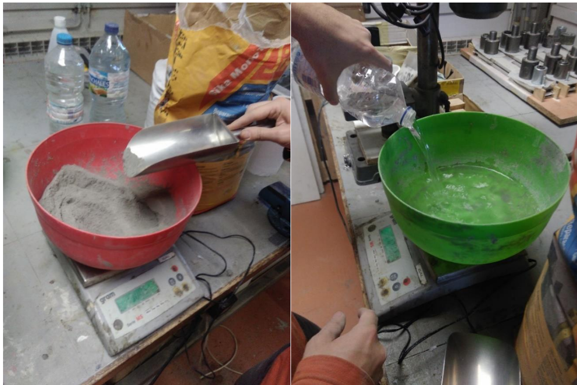
FIGURA 18 DOSIFICACIÓN DE MORTERO Y AGUA. Ídem.
