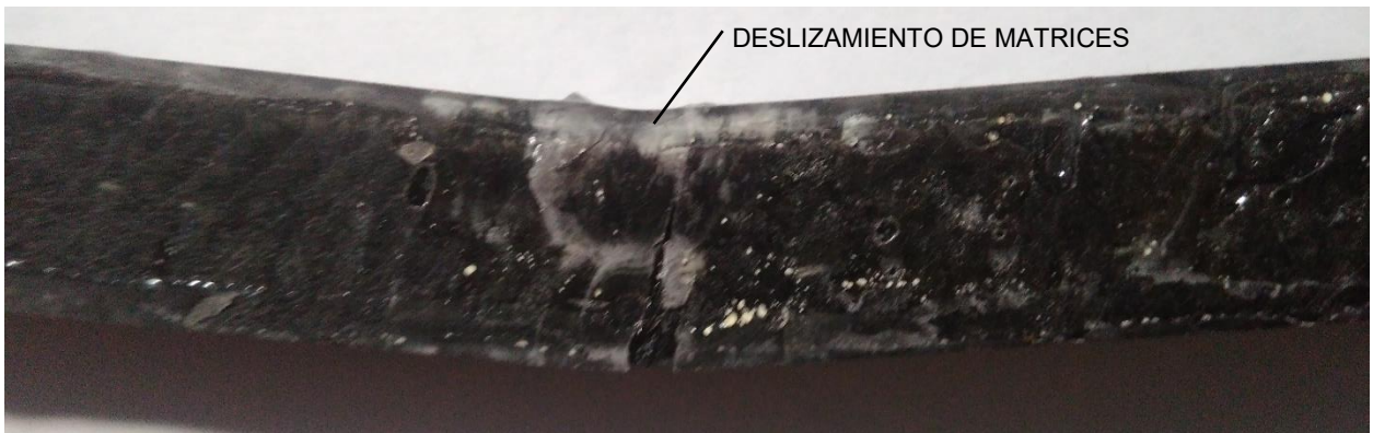
FIGURA 119 PROBETA D790-03 FRACTURA FRÁGIL (PARED VERTICAL)
