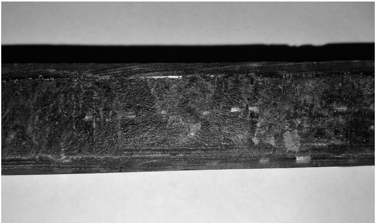
FIGURA 160 PROBETA D1435-02, DETALLE ENVEJECIMIENTO A LA INTEMPERIE.
