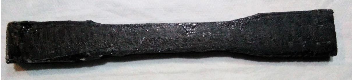
FIGURA 64 PROBETA FINAL D 638 CONFINADA EN FC A 20° (FRENTE).
