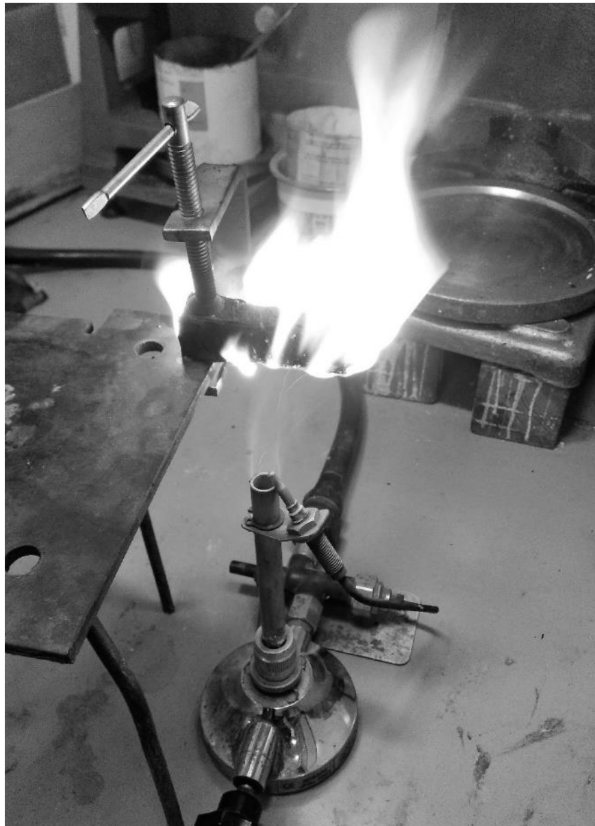
FIGURA 128 PROBETA D635 EN PROCESO DE CARBONIZACIÓN. Ídem.
