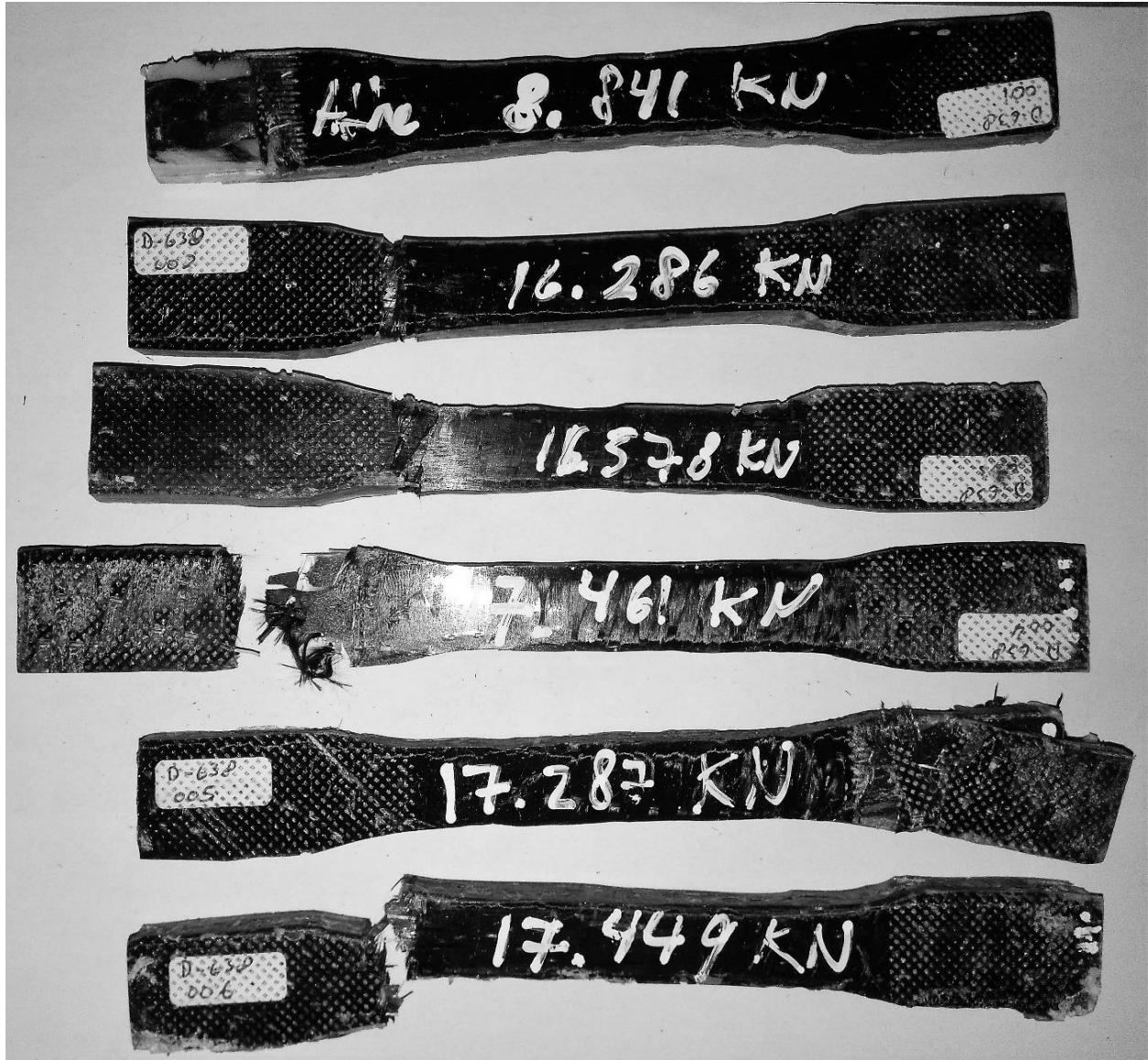
FIGURA 87 ENSAYOS SEGUNDO GRUPO DE PROBETAS D638, LAMINADO POR CONFINAMIENTO.
