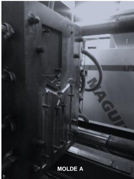
FIGURA 45 MOLDES METÁLICOS PARA MÓDULOS BAJO LAS NORMAS D 638 Y D695. Ídem.
