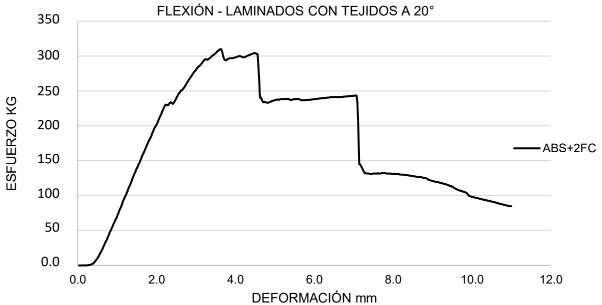
GRÁFICA 13 COMPORTAMIENTO MECÁNICO A FLEXIÓN DEL COMPUESTO ABS+FC ORIENTACIÓN COMBINADA DEL REFUERZOS.
