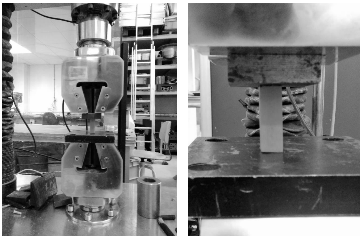
FIGURA 170 MONTAJE NÚCLEO DE ABS PARA ENSAYO DE COMPRESIÓN. Fotografía del equipo tomada con permiso del Laboratori per a la Innovació Tecnològica d'Estructures i Materials (LITEM) y la Universidad Politècnica de Catalunya (UPC).
