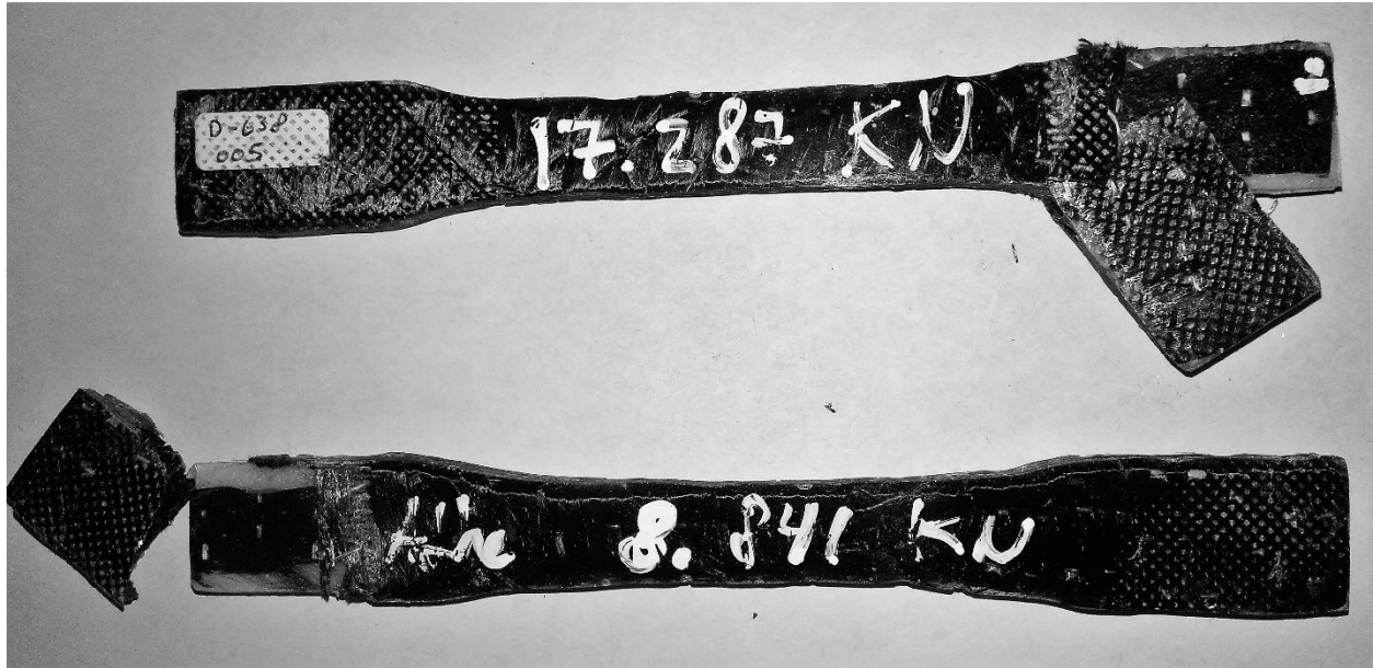
FIGURA 138 PROBETAS D3163-D Y D3163-E (probetas que se utilizaron en ensayo de tensión y que presentaron falla por adherencia de tejidos y matrices de refuerzo)
