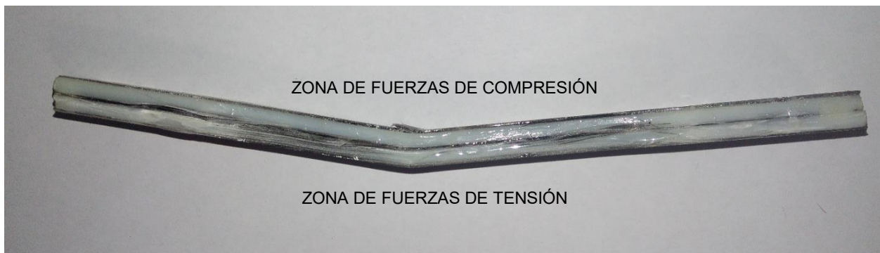
FIGURA 110 PROBETA D790-01 ENSAYADA A FLEXIÓN.
