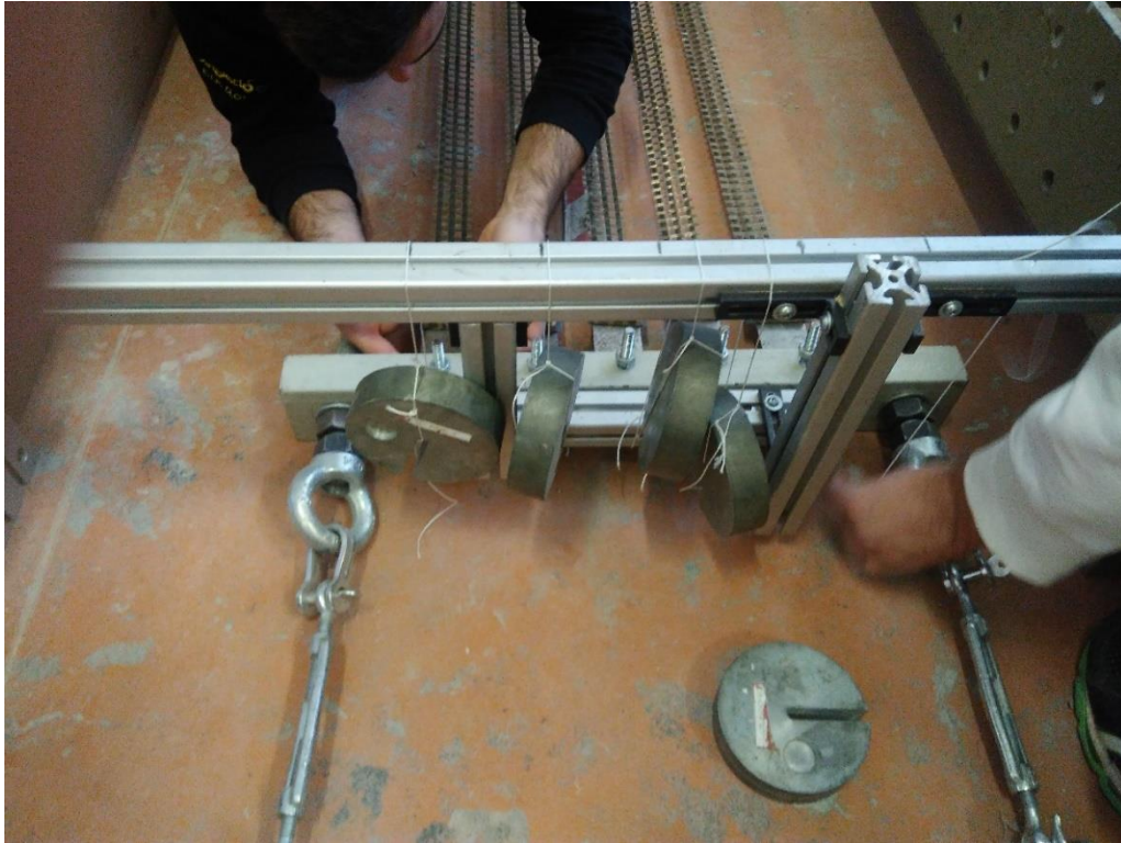
FIGURA 10 COLOCACIÓN DE PESOS NIVELADORES DE PLACAS. Ídem.
