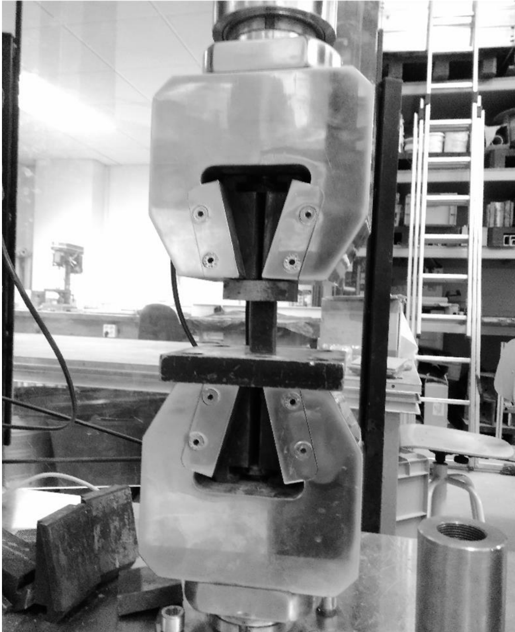
FIGURA 100 PROBETA D695 CORTA PREPARADA PARA ENSAYO DE COMPRESIÓN. Fotografía del equipo tomada con permiso del Laboratori per a la Innovació Tecnològica d'Estructures i Materials (LITEM) y la Universidad Politècnica de Catalunya (UPC).
