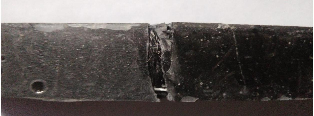
FIGURA 118 PROBETA D790-02 FRACTURA FRÁGIL (PARED HORIZONTAL)
