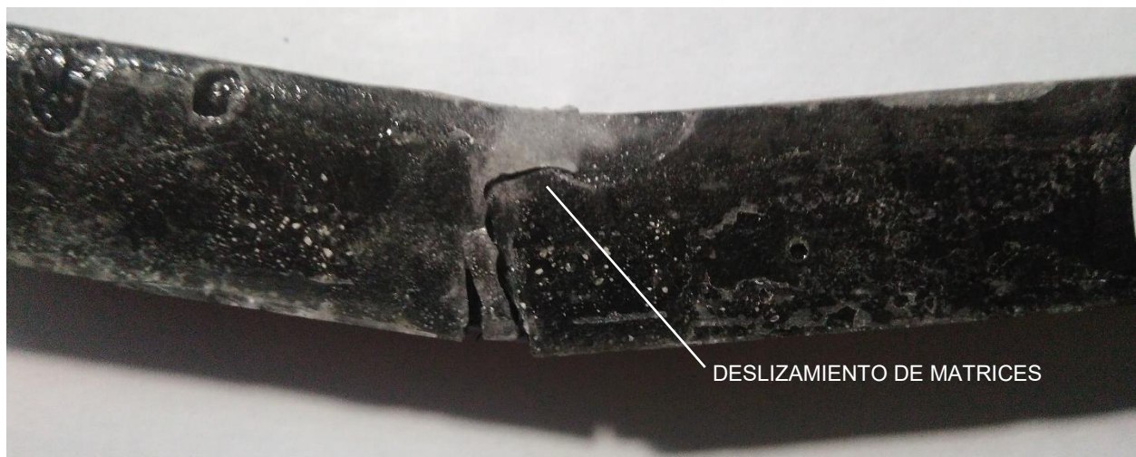
FIGURA 117 PROBETA D790-02 FRACTURA FRÁGIL (PARED VERTICAL)
