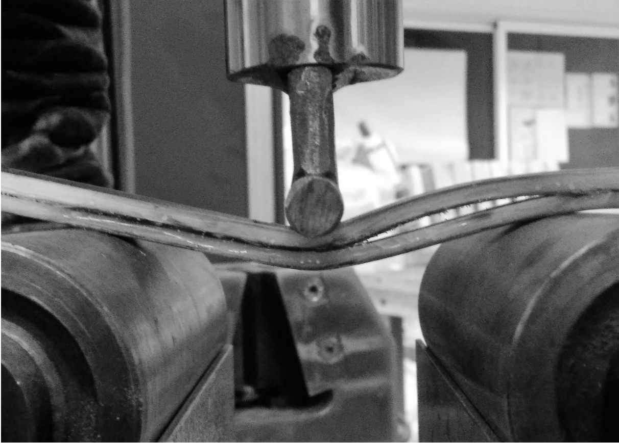
FIGURA 113 PROBETA D790-04 DELAMINACIÓN DURANTE ENSAYO DE FLEXIÓN. Fotografía del equipo tomada con permiso del Laboratori per a la Innovació Tecnològica d'Estructures i Materials (LITEM) y la Universidad Politécnica de Cataluña (UPC).
