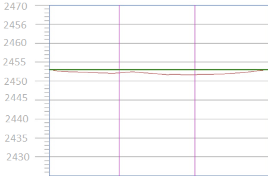
Figura 2. 6 Zoom de la cuneta que se forma en la calle Las Torres
