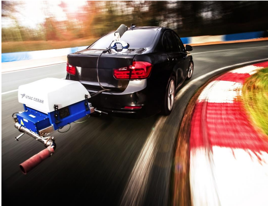
Fig. 2.20 Prueba a bordo de PEMS [26]
