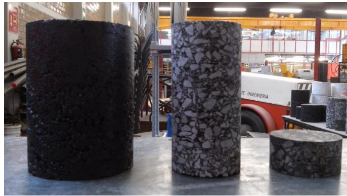
Fig. 3-2. Especímenes de concreto asfáltico preparados en el laboratorio.
