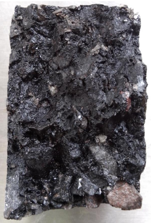
Fig. 3-19. Aspecto de los especímenes de concreto asfáltico después de la aplicación de compresión diametral.
