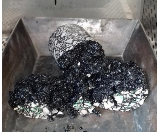
Fig. 3-43. Disgregado de los cilindros de concreto asfáltico durante dos horas a 100 °C
