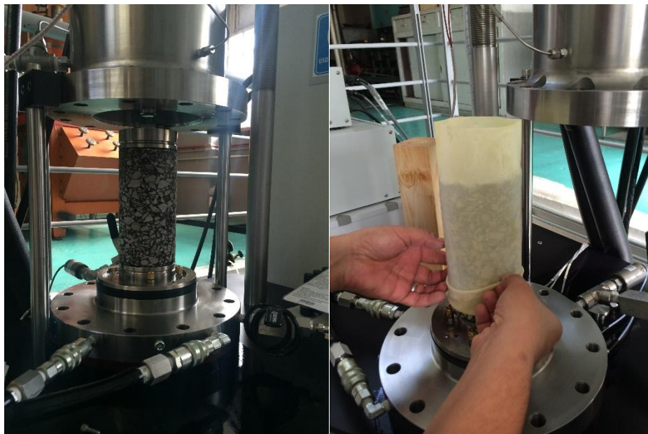
Fig. 3-21. Montaje de los especímenes de concreto asfáltico en la cámara triaxial.
