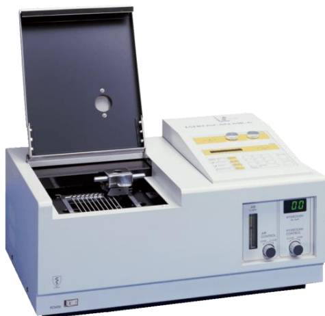
Fig. 3-47. Equipo IATROSCAN MK-6s ® , utilizado para determinar las fracciones SARA del asfalto.
