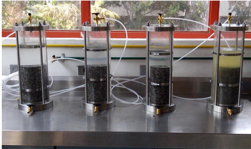
Fig. 3-17. Equipo de saturación conteniendo en su interior las especímenes cilíndricos de concreto asfáltico saturándose.
