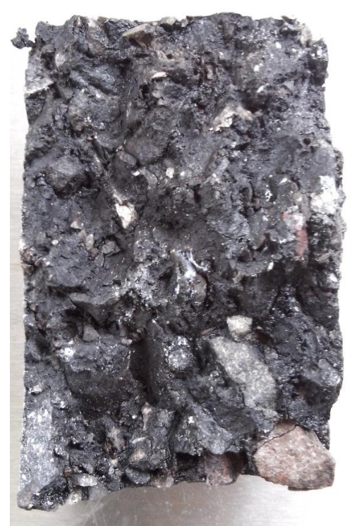
Fig. 3-19. Aspecto de los especímenes de concreto asfáltico después de la aplicación de compresión diametral.
