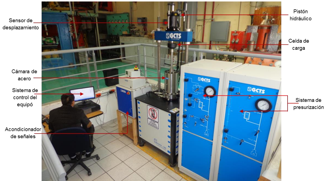
Fig. 3-20. Equipo para ensayos de compresión triaxial.
