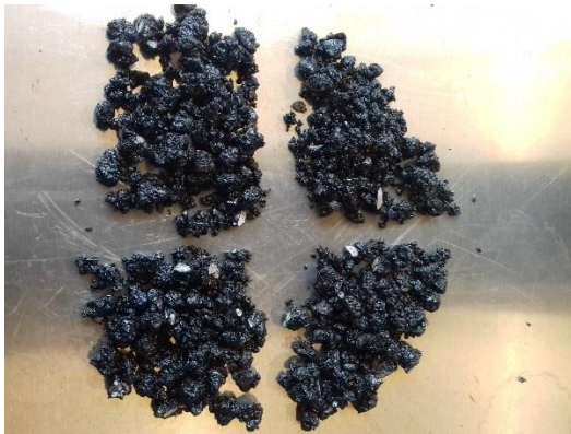
Fig. 3-44. Obtención de una muestra representativa mediante cuarteos sucesivos
