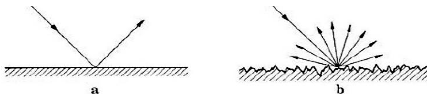
Figura 3.8 Reflexión especular (a) y difusa (b).
