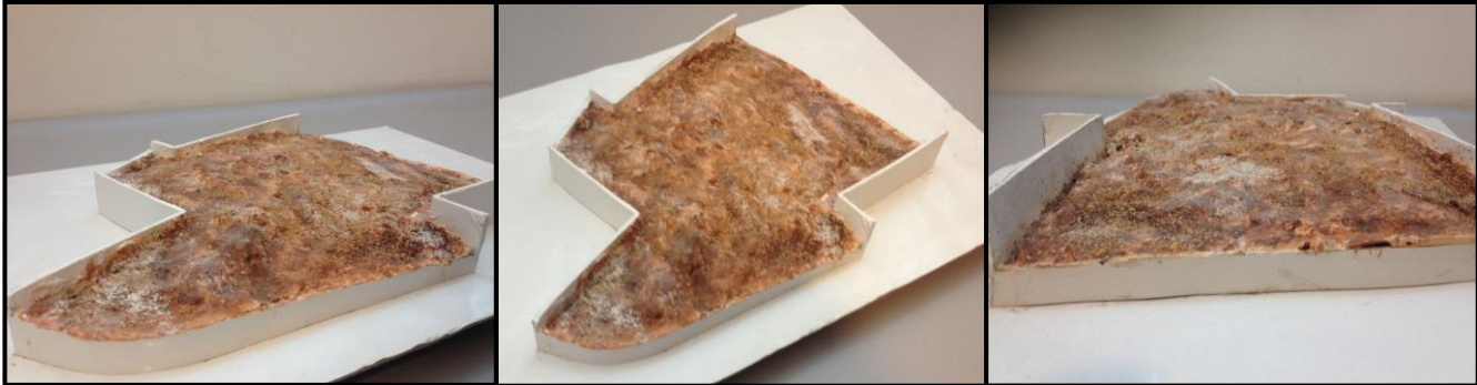
Imagen 6.10: La pendiente se analizó con una maqueta del terreno para poder observar con detenimiento las pendientes y así poder hacer una mejor propuesta. En un principio se buscaba zonas planas para poder poner las canchas deportivas sin embargo teniendo el volumen nos permitió hacer una propuesta interesante que consistía en unir las circulaciones para discapacitados con las normales y por eso el proyecto quedó resuelto en rampas.
