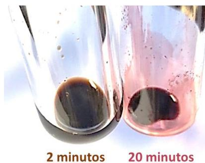
**Figura 2.4.** Cambio de color en la descomposición del hidruro de paladio en disolución pasado 20 minutos a condiciones normales.
