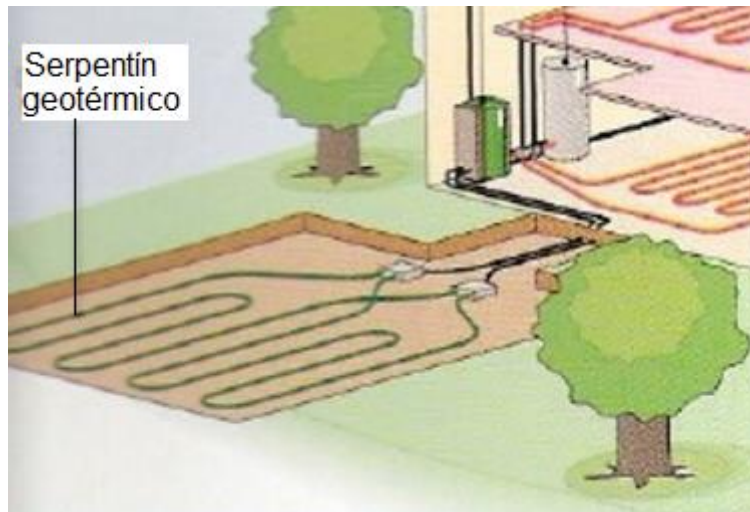
Figura 2.6. Serpentín horizontal cerrado en forma de U.
