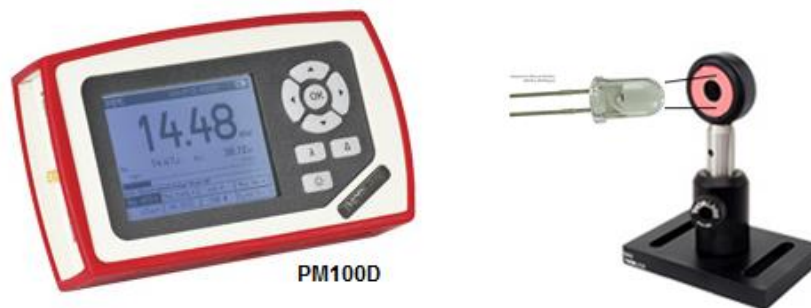
Fig. 2.3. Consola y sensor para medición de potencia.
