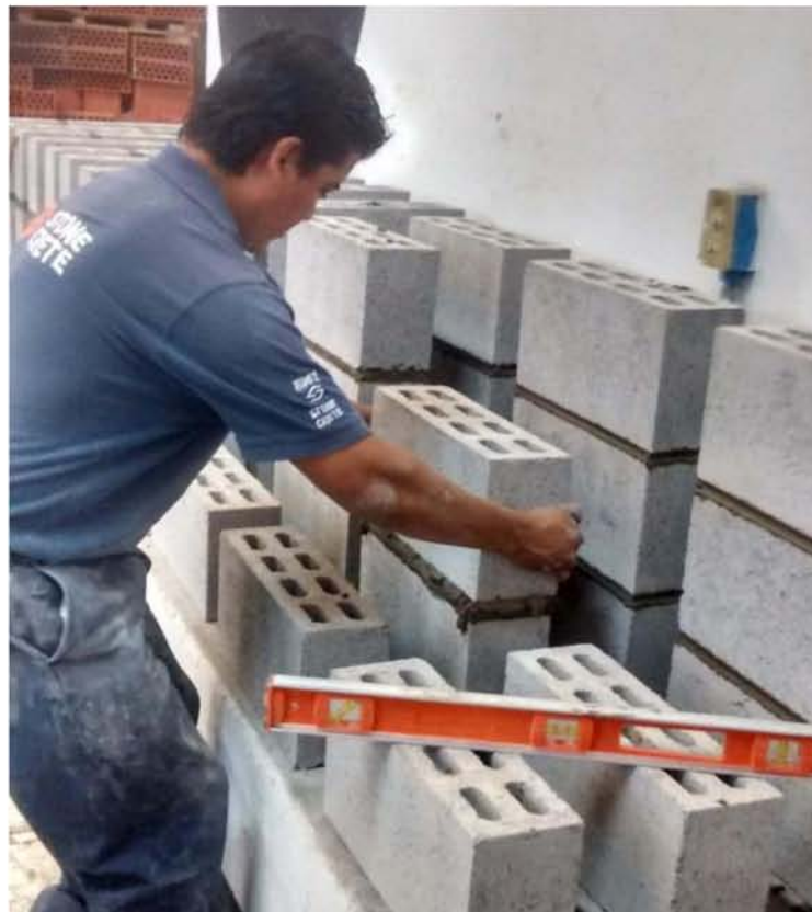
Fig. 2.2 Proceso Constructivo de pilas para pruebas a compresión, piezas del tipo BH8 IBMEX. 3
