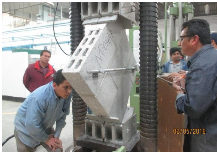
Fig. 2.15 Determinación del modulo a cortante en muretes de mampostería (piezas multiperforadas tipo “BH8 IBMEX”). 3
