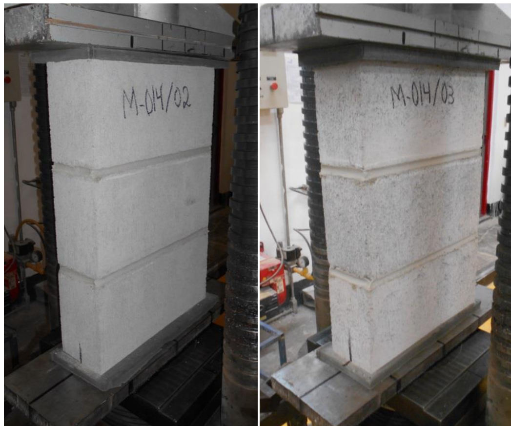
Fig. 2.4 Pilas Sujetas a Compresión (antes de iniciar la carga). 3
