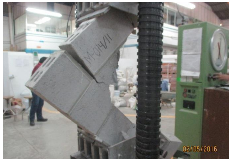
Fig. 2.14 Murete sujeto a compresión diagonal (Se observan la falla a través de las piezas y de la junta de mortero “tercer modo de falla”). 3
