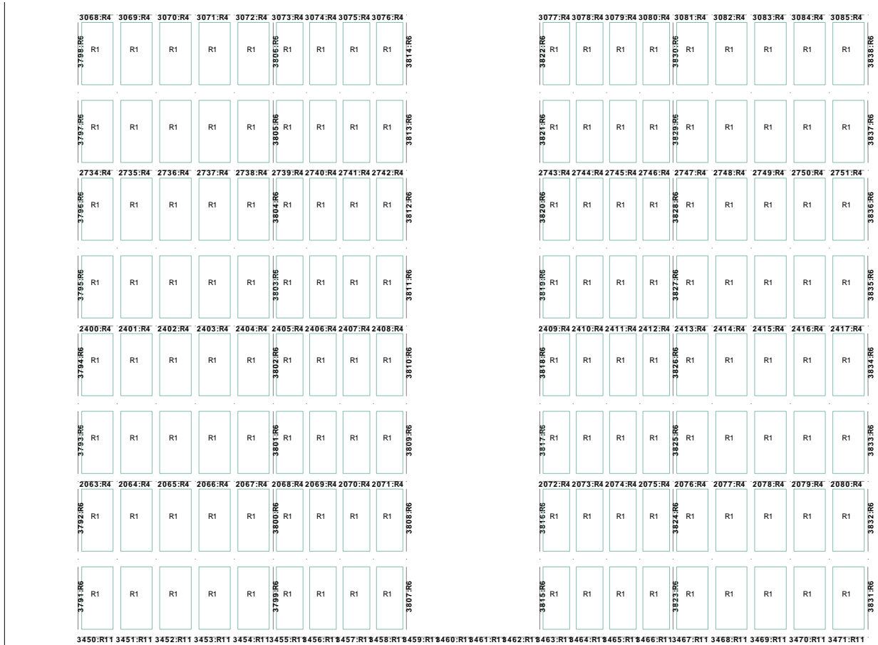
Fig. 5. 27 Se muestra la numeración de las barras y el número de propiedad que conforman a los castillos y dalas de los muros 1 y 2.
