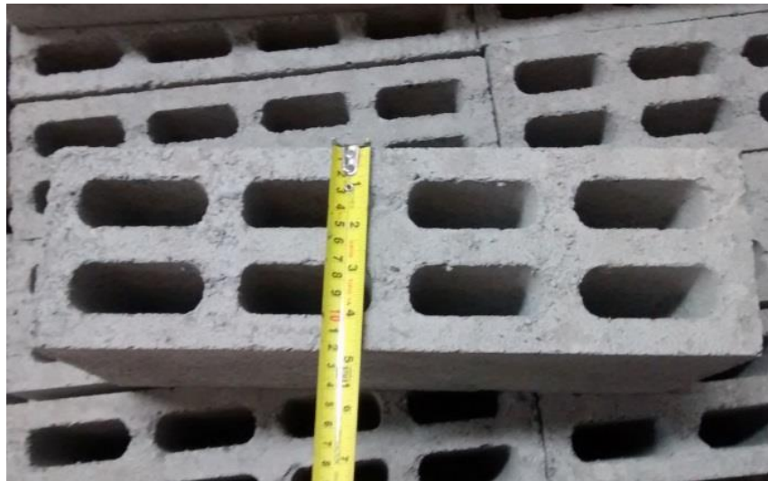
Fig. 1.1 Ancho nominal de una pieza múltiperforada de Block IBMEX BH8 3
