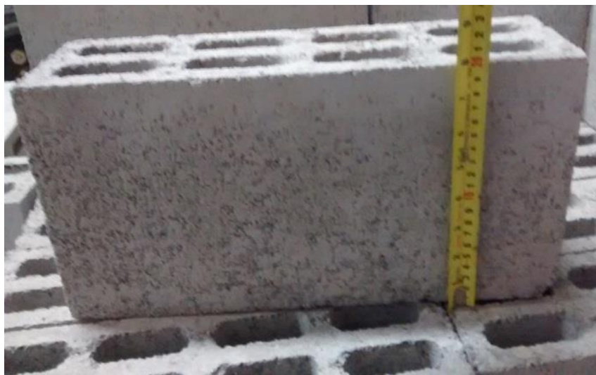
Fig. 1.3 Altura nominal de una pieza múltiperforada de Block IBMEX BH8 3
