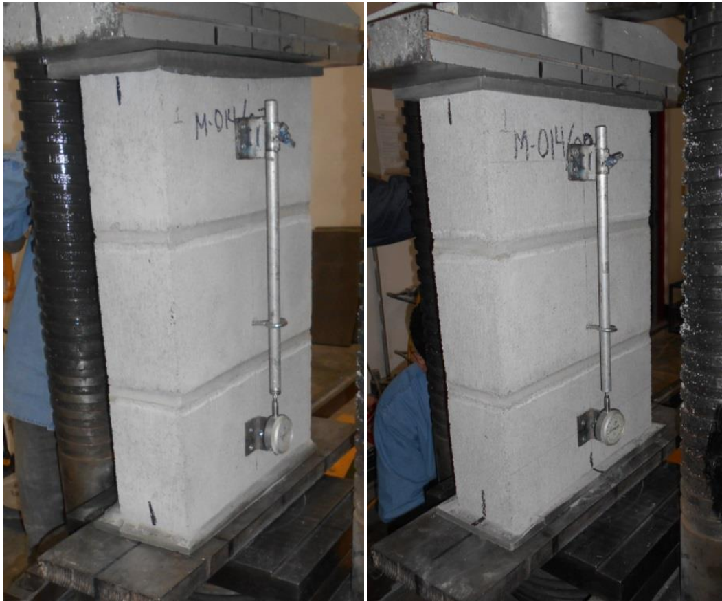
Fig. 2.7 Determinación del Modulo de Elasticidad a través de Pilas de mampostería sujetas a compresión axial (piezas BH8 IBMEX). 3
