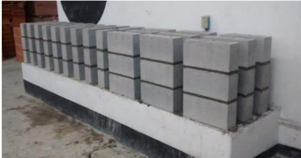
Fig. 2.3 Pilas para pruebas a compresión, piezas del tipo BH8 IBMEX. 3
