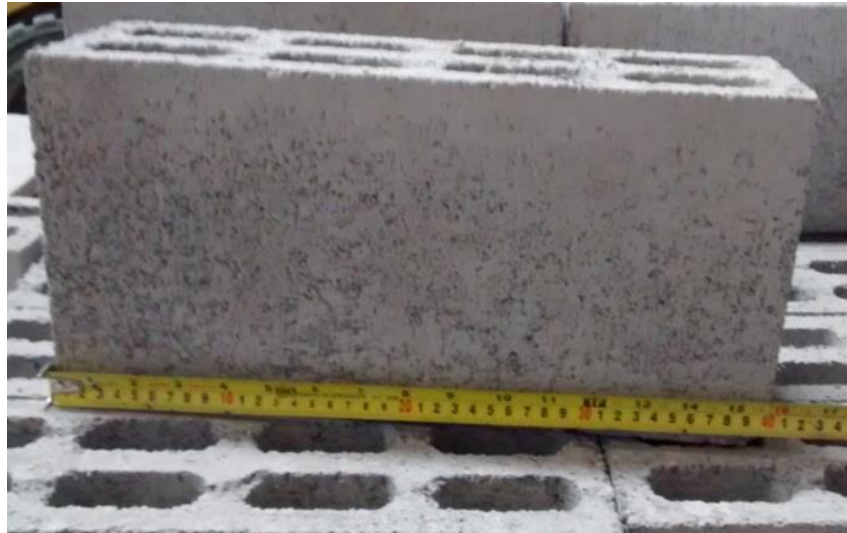
Fig. 1.2 Largo nominal de una pieza múltiperforada de Block IBMEX BH8 3
