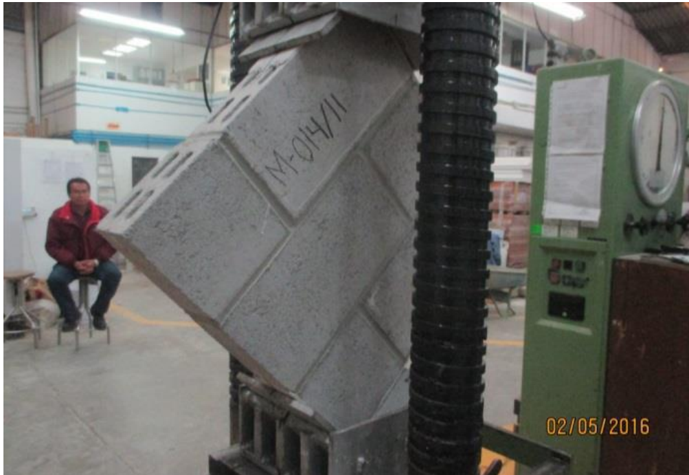
Fig. 2.12 Muretes sujetos a compresión diagonal (antes de iniciar la carga). 3
