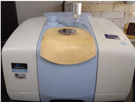
Fotografía 3. Perkin Elmer Spectrum 100 con accesorio universal de muestro ATR punta de diamante.
