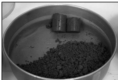
**Figura 4.4. Material mezclado con CaO**
