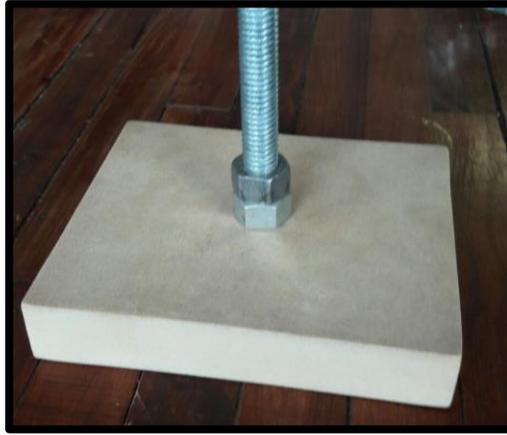
**Fig. 8.15 Base del prototipo en el cual se aprecia la forma de sujeción por medio de tuercas. [Fuente: Elaboración propia]**
