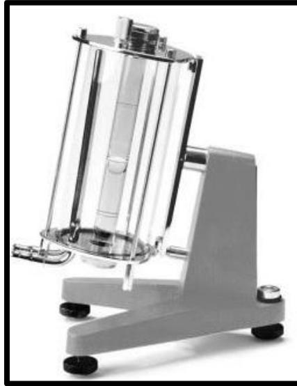
Fig. 5.10 Viscosímetro caída de bola. [Fuente: 3B Scientific]
