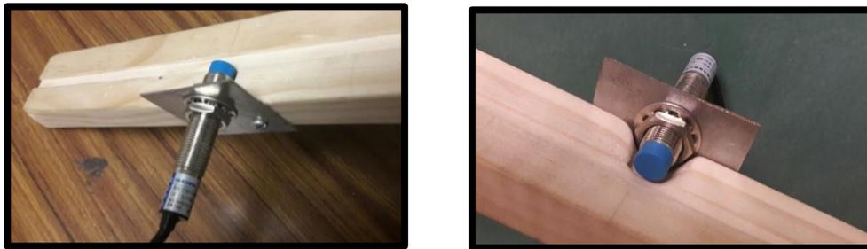
**Fig. 8.19 Montaje de los soportes en el canal del balón. [Fuente: Elaboración propia]**
