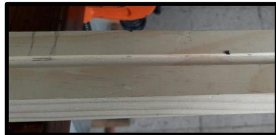
**Fig. 8.16 Corte del canal para el balín. [Fuente: Elaboración propia]**
