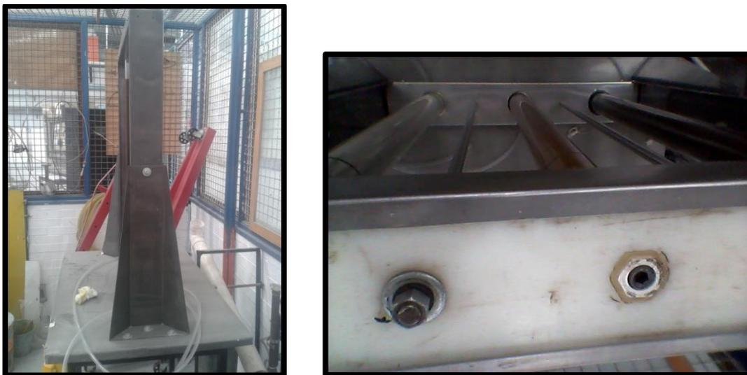
**Fig. 3.3 Perno que sirve para que el dispositivo gire (izquierda), sujeción de los tubos de acrílico en la parte superior sin sellar (derecha). [Fuente: Elaboración propia]**
