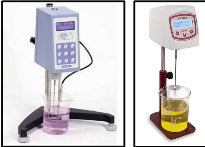
Fig. 5.6 Viscosímetro rotacional ST-2020 JP SELECTA (izquierda) y Viscosímetro VP 1000 M (derecha) [Fuentes: ictsl ; viscotech]
