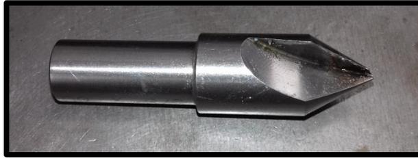
**Fig. 8.5 Avellanador utilizado para el receptáculo del balín. [Fuente: Elaboración propia]**
