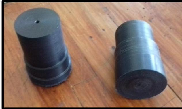
**Fig. 8.3 Tapones con corte de aproximación. [Fuente: Elaboración propia]**
