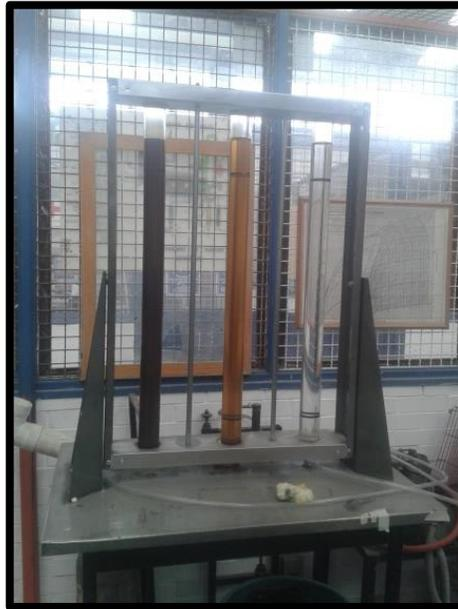
Fig. 6.2 Viscosímetro actual del laboratorio de la Facultad de Estudios Superiores Aragón. [Fuente: Elaboración propia]
