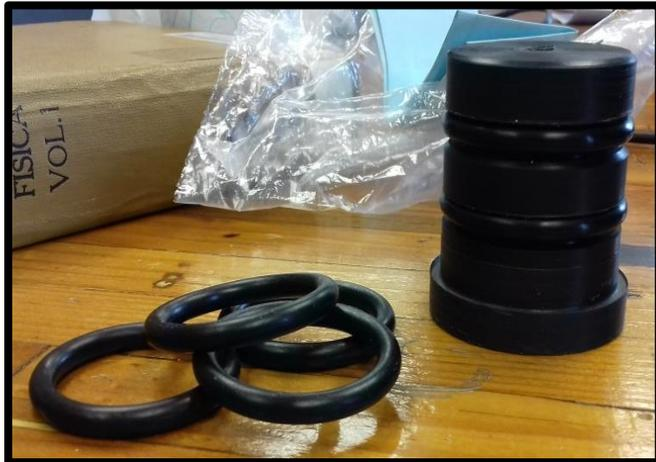
**Fig. 8.7 Tapones terminados con los o-rings colocados en sus ranuras. [Fuente: Elaboración propia]**
