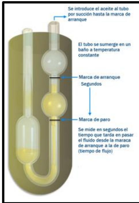
Fig. 5.8 Esquema estándar de funcionamiento de viscosímetro capilar. [Fuente: Lublearn]
