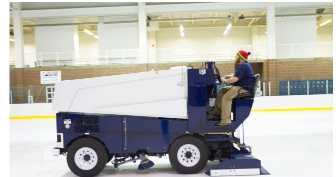
Zamboni: máquina que reacondiciona la superficie del hielo FUENTE: http://universe.byu.edu/wp-content/uploads/2013/02/Zamboni_04.jpg
