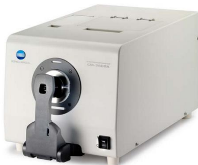
Figura 15. Espectrofotómetro Konica Minolta CM-3600d.
