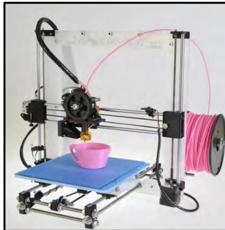
Figura 43. Impresora de prototipo rápido Prusa I3 (MakerMex, 2017).
