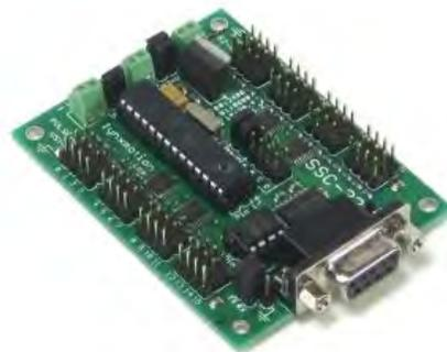
Figura 40. lynxmotion-ssc-32 tomado de (RobotShop inc, 2017).
