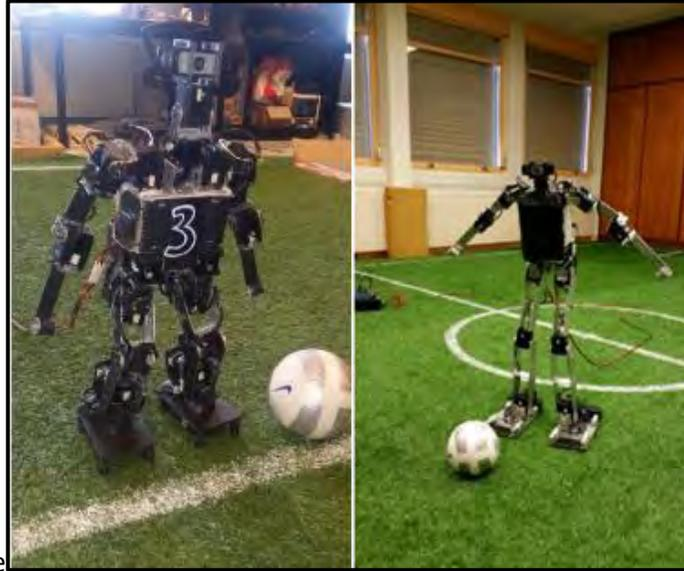
Figura 7. Robot Sigmaban 1.4 (izquierda) y Grosban (derecha) tomado de (Fabr et al. 2016).
