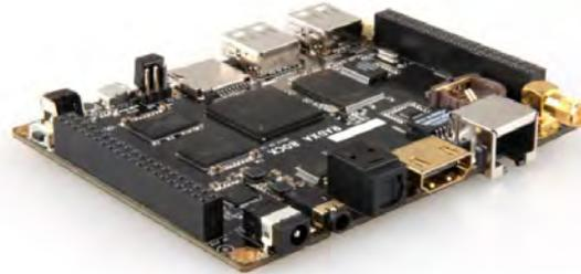
Figura 39. Tarjeta Radxa imagen obtenida de (Radxa Limited, 2017)
