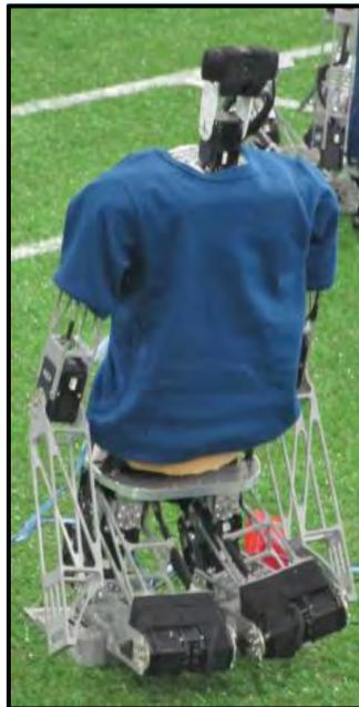
Figura 8. Robot ARASH tomado de (Sadeghnejad et al., 2016).
