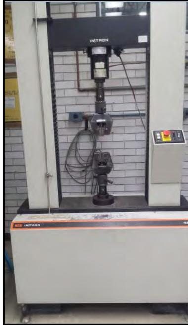
Figura 53. Máquina Instron para ensayo de tracción.
