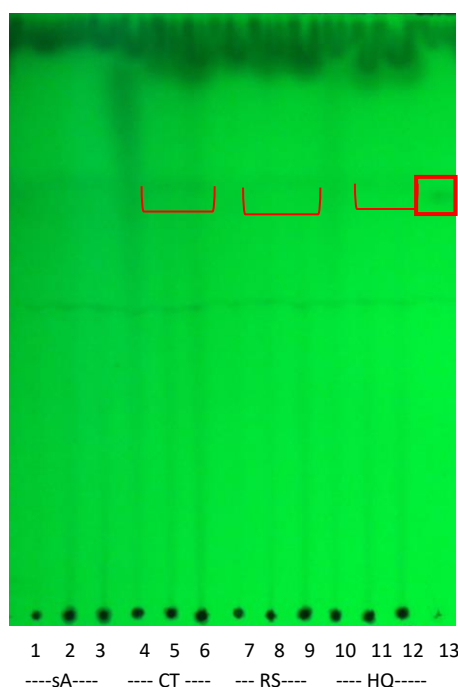
Figura 12a. Análisis de TLC para reacciones catalizada con DXS, reveladas con UV (254 nm). Control sin aglicona (sA), catecol (CT), resorcinol (RS) e hidroquinona (HQ). Carriles 1, 4, 7, 10: tiempo inicial de reacción; 2, 5, 8, 11: 14horas de reacción; 3, 6, 9, 12: 40 horas de reacción. Carril 13: estándares sacarosa, fructosa y arbutina.
