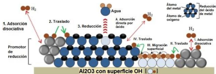
Figura 2.5.3 Ejemplo de catalizador usado en el proceso de Fischer-Tropsch. Tomado de [75].
