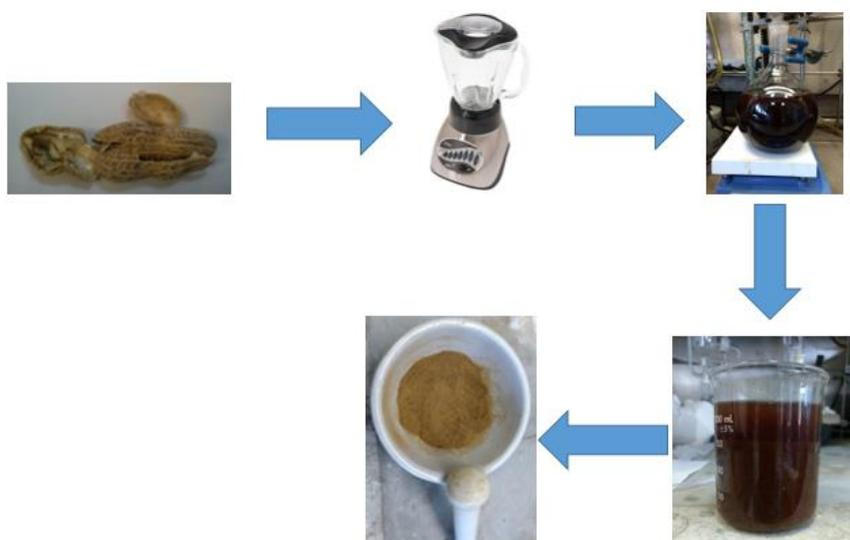
Figura 3.3.1 Diagrama experimental. Preparación de las muestras de materia orgánica (cáscara de cacahuete).
