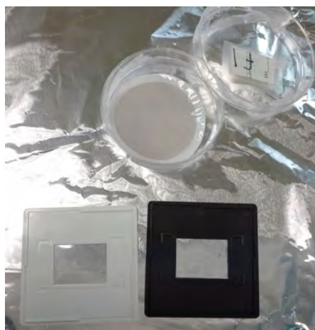
Figura 2.11: Filtro de policarbonato y el marco en el cual se montaron las muestras para su análisis.
