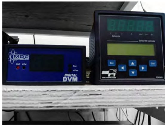
Figura 1.16: Indicadores de vacío del espectrómetro de rayos X, del Laboratorio de Aerosoles (Izq. termopar, Der. cátodo frío).
