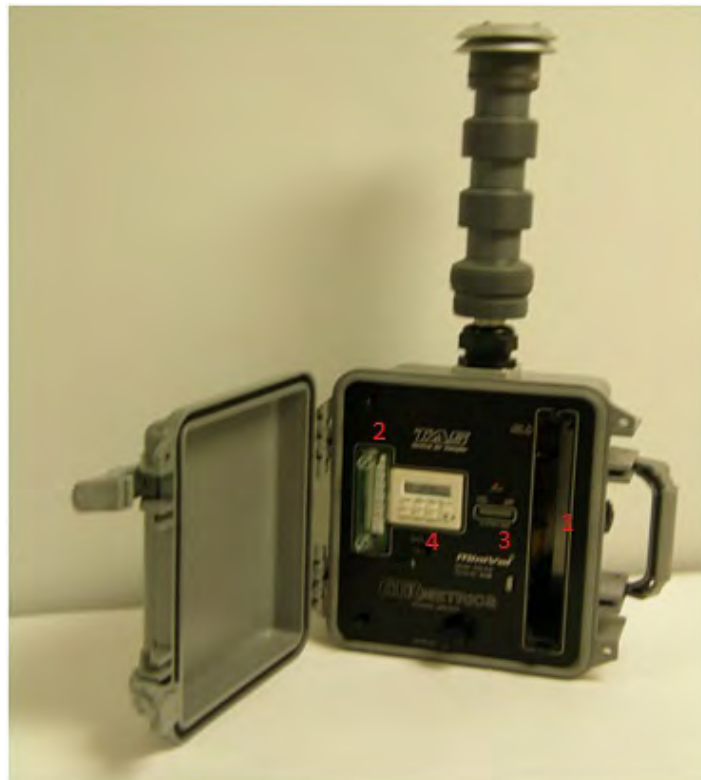
Figura 1.18: Muestreador MiniVol marca TAS [47].
