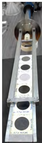
Figura 2.6: Posicionador del espectrómetro de rayos X para seis muestras.
