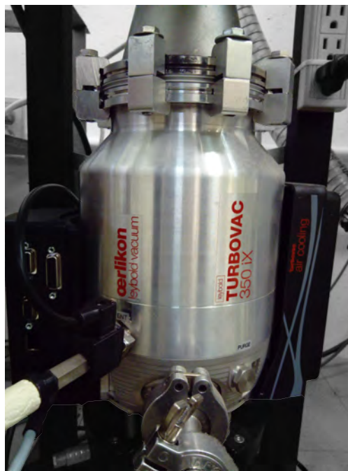
Figura 1.14: Bomba turbomolecular del Laboratorio de Aerosoles, IFUNAM.
