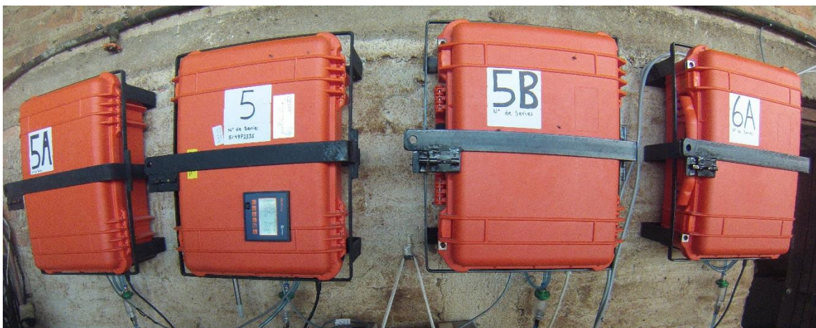
Figura 1. Instalaciones para el muestreo de metano en ordeñas en Tepatitlán de Morelos, Jalisco. Guardian NG- Infrared Gas.
