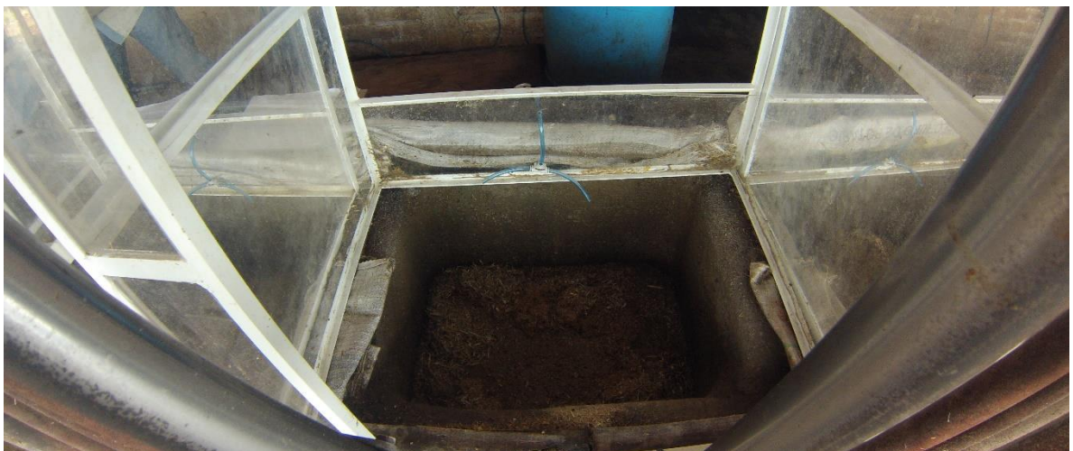
Figura 4. Instalaciones para el muestreo de metano en ordeñas en Tepatitlán de Morelos, Jalisco. Manguera recolectora de \text{CH}_4 .
