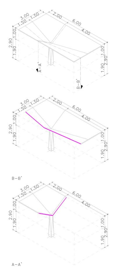
lmg. 112. Paraguas de concreto BFUP estructural, formado a partir de la unión de cuatro secciones hiperbólicas (geométricamente).
