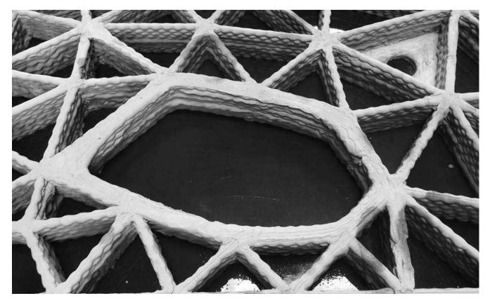
lmg. 38. Maqueta escala 1:1, Pared con propiedades de aislamiento térmico impresa en concreto BFUP.
