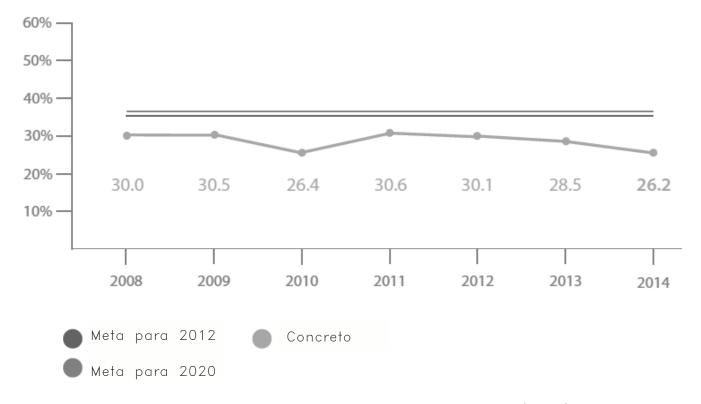
Img. 31. Reducción de cementantes en mezclas de concreto (2014).
