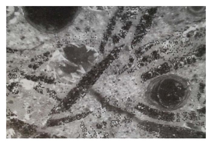
lmg. 37. Distribución aleatoria de fibras de vidrio AR en concreto compuesto.
