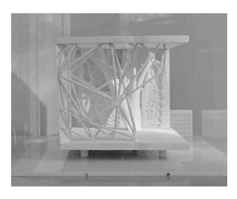
Img. 39. Modelo a escala de un pabellón base concreto de súper alto desempeño, en el cual se busca optimizar la estructura algorítmicamente.
