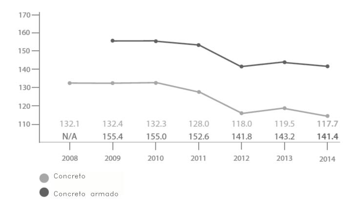
lmg. 30. Gráfica: costo energético (kWh/Ton) para la producción de concreto y concreto armado.
