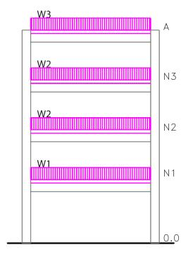
lmg. 125. Corte esquematico, distribución de cargas en el edificio.
