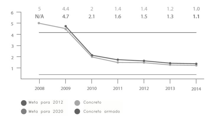
Img. 32. La siguiente gráfica muestra la relación existente entre concreto (Ton) y los residuos depositados en vertederos como productos del mismo (Kg).
