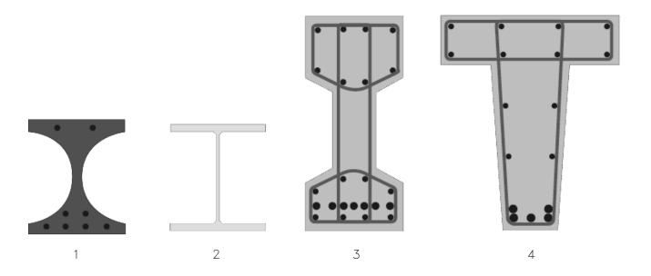
lmg. 35. Comparativo de cuatro vigas capaces de resistir una mismas carga Q, pero con diferentes materiales.
