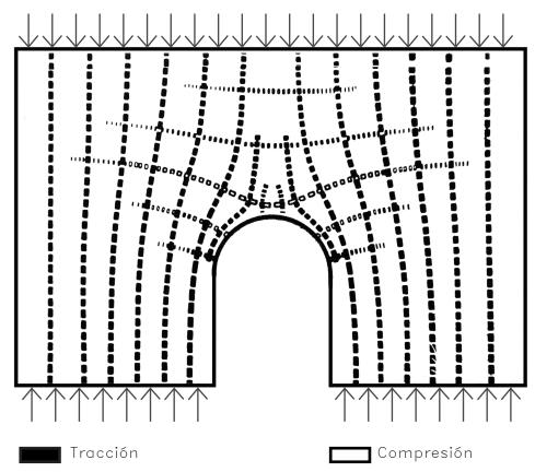
Img. 54. Diagrama de isostáticas correspondiente al comportamiento tensional de un arco enjutado.
