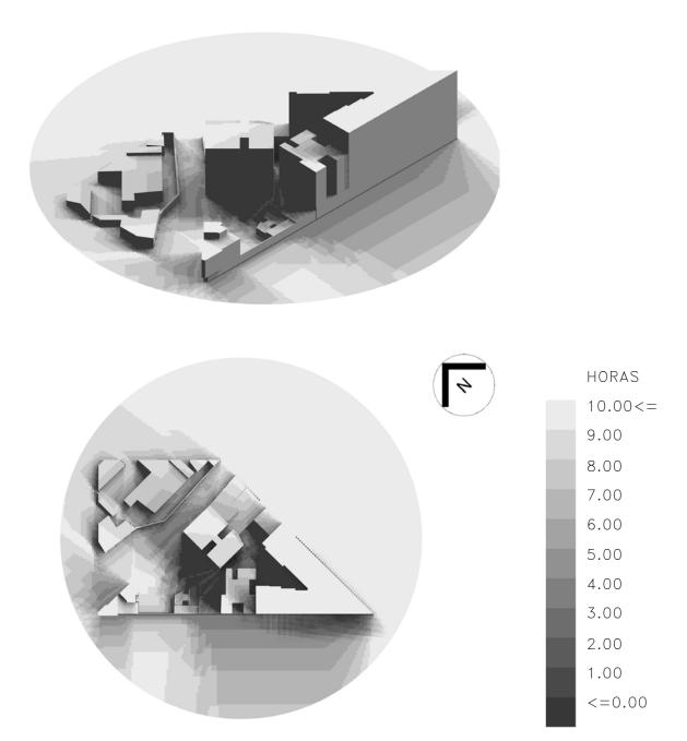
lmg. 74. Planta, horas efectivas de luz al día lmg. 75. Isométrico de horas efectivas de luz al día
