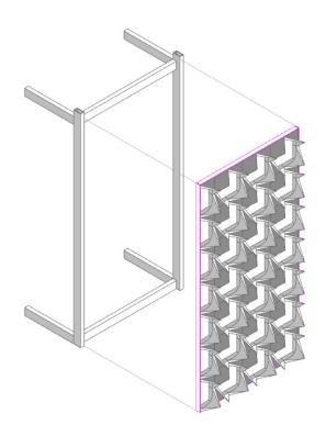
Img. 96. La unión de las piezas de prefabricados hiperbólicos permite la formación de patrones más complejos en fachada.
