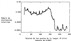
Fig. III.1 Ejemplo de un histograma de intensidad. Los valores de intensidad están cuantificados con 8 bits en el rango de 0 a 255.
