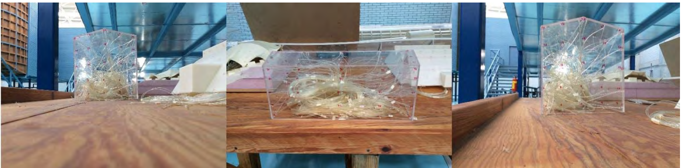
Figura 5.5. Modelo de Nave industrial a dos aguas instrumentado.
