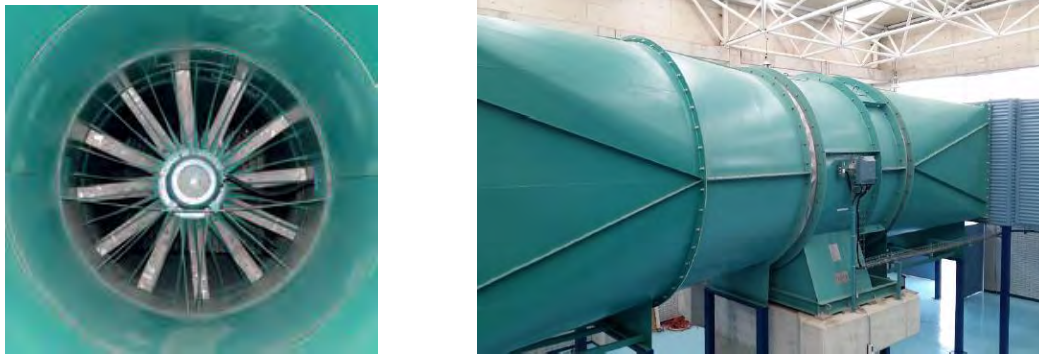
Figura 4.6. Ventilador del túnel de la UNAM
