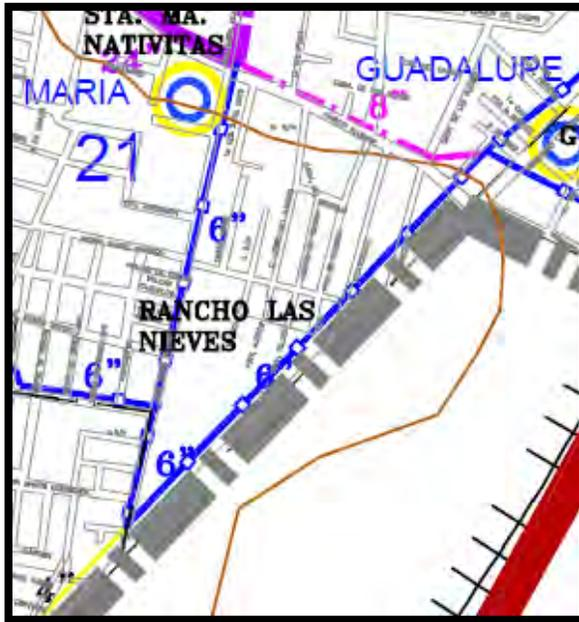
El recorrido que hará la red de agua potable será de la red del municipio hacia el cuadro de red general ubicado en la zona de servicios, el cual abastecerá una cisterna, por medio de equipos hidroneumáticos se abastecerán los edificios del proyecto.
