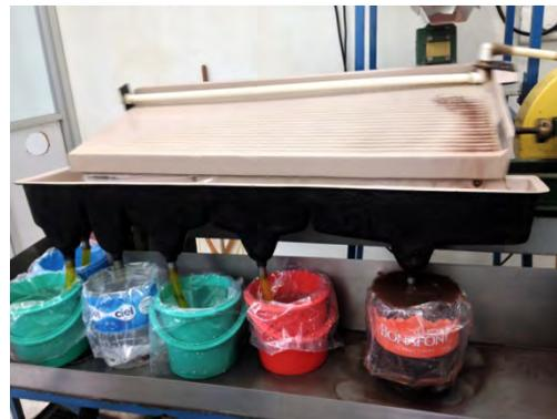
*Figura 2.3. Separación de minerales pesados mediante el separador hidráulico y vibratorio.*
