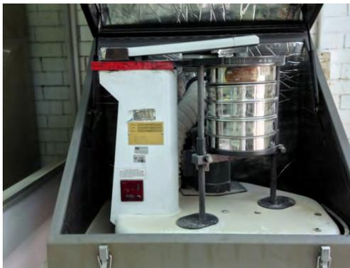
*Figura 2.2. Tamizado de muestras para obtención de fracciones 100, 200 y <200.*
