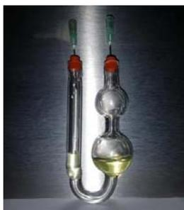
Figura 15. Vial para irradiación.
