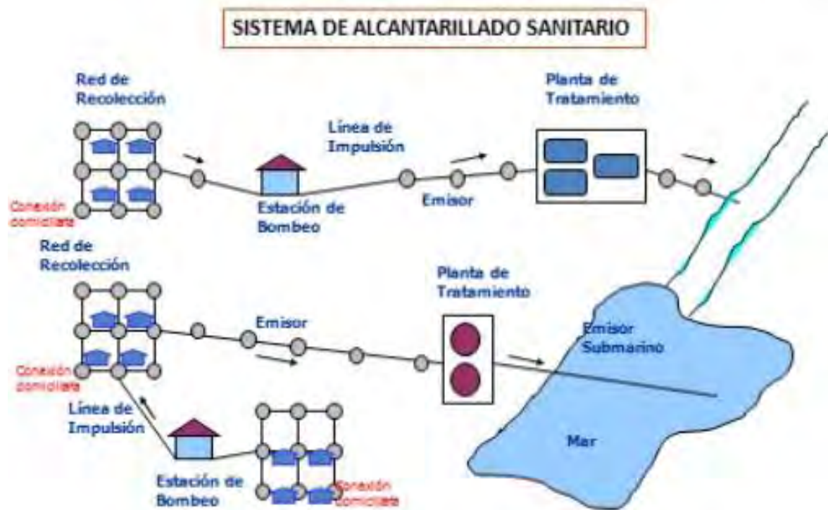
Imagen 4: Sistema de alcantarillado sanitario.
