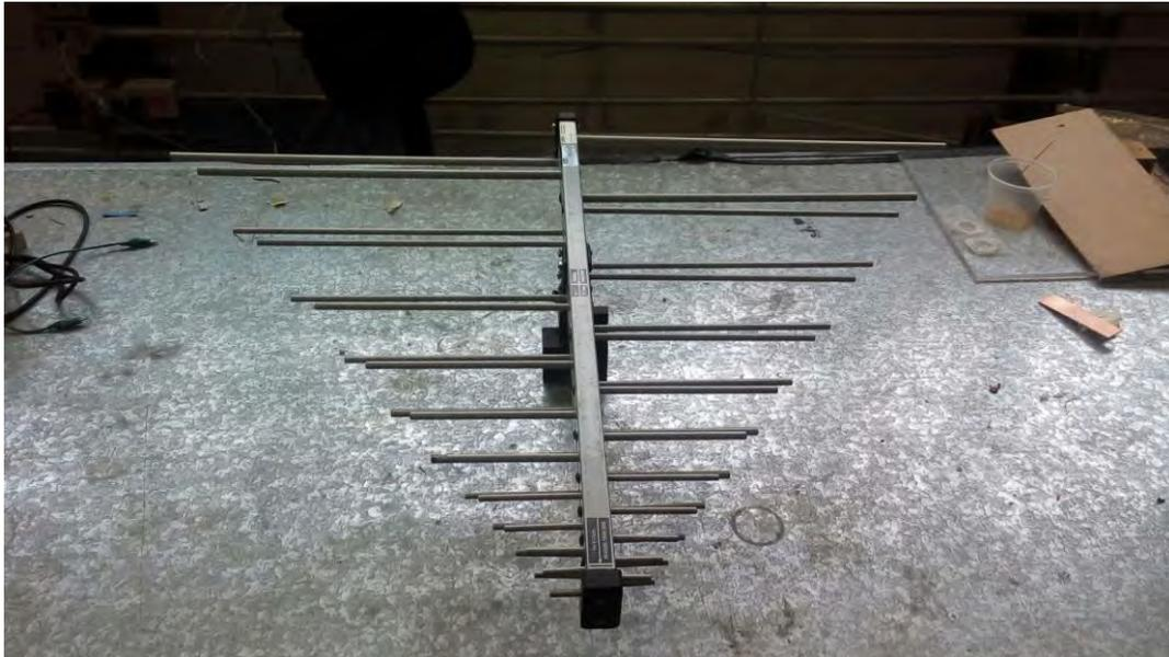
**Figura 2.12 Antena logarítmica Modelo 3148**
