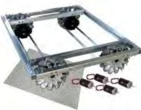
*Figura. 9. Plataforma omnidireccional a caracterizar.*
