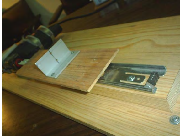
Figura 7.1.14. Vista general de mesa vibradora, con ángulo de aluminio para la base del marco y riel de desplazamiento.
