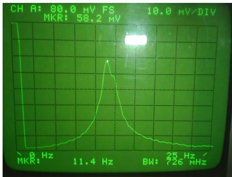
Figura 7.2.1. Vista del espectro de respuesta obtenido con el analizador de espectros 3582A Spectrum Analyser Hewlett Packard , debido a la vibración generada en la masa del TMD con la placa de cobre adherida y representa al elemento inferior del par con una frecuencia de 11.4 Hz.
