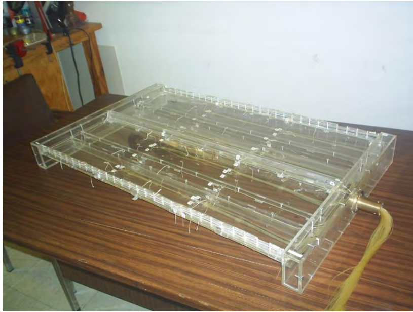
Figura 4.1.2.2. Vista del modelo elaborado en acrílico en el que se aprecia la restricción en el extremo para ensaye en el túnel de viento y los apoyos cilíndricos en la zona central de los extremos.
