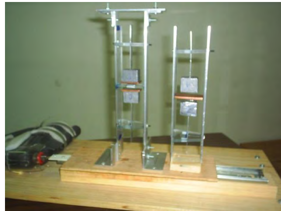
Figura 7.1.25. Vista de los dos modelos, donde se aprecia la diferencia de configuración en la zona en que se genera el amortiguamiento magnético, uno de los cuales se encuentra montado en el marco de soporte y en la mesa vibradora.
