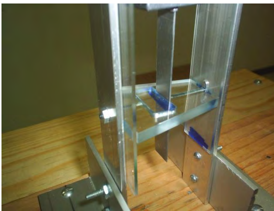
Figura 7.1.20. Ángulos de la base del marco de soporte del modelo y conexiones del marco y del modelo
