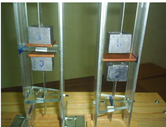
Figura 7.1.25. Vista de los dos modelos, donde se aprecia la diferencia de configuración en la zona en que se genera el amortiguamiento magnético, uno de los cuales se encuentra montado en el marco de soporte y en la mesa vibradora.
