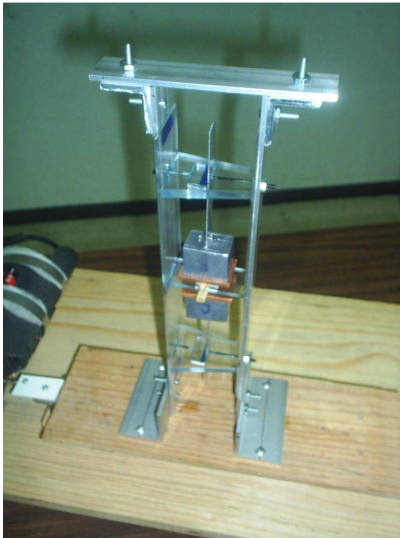
Figura 7.1.23. Vista general del modelo con un solo imán montado en el marco de soporte y sujeción de éste a la mesa vibradora.
