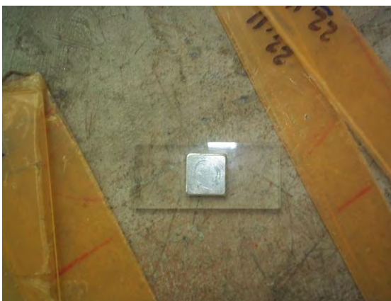
Figura 7.1.16. Imán central con soporte de acrílico para el modelo, con un solo imán intermedio, y placas de cobre adheridas a las masas.
