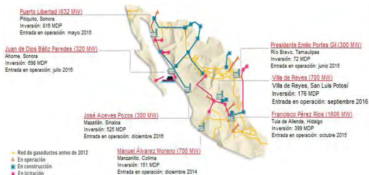
Figura 2.3. Centrales termoeléctricas de conversión a combustión dual
