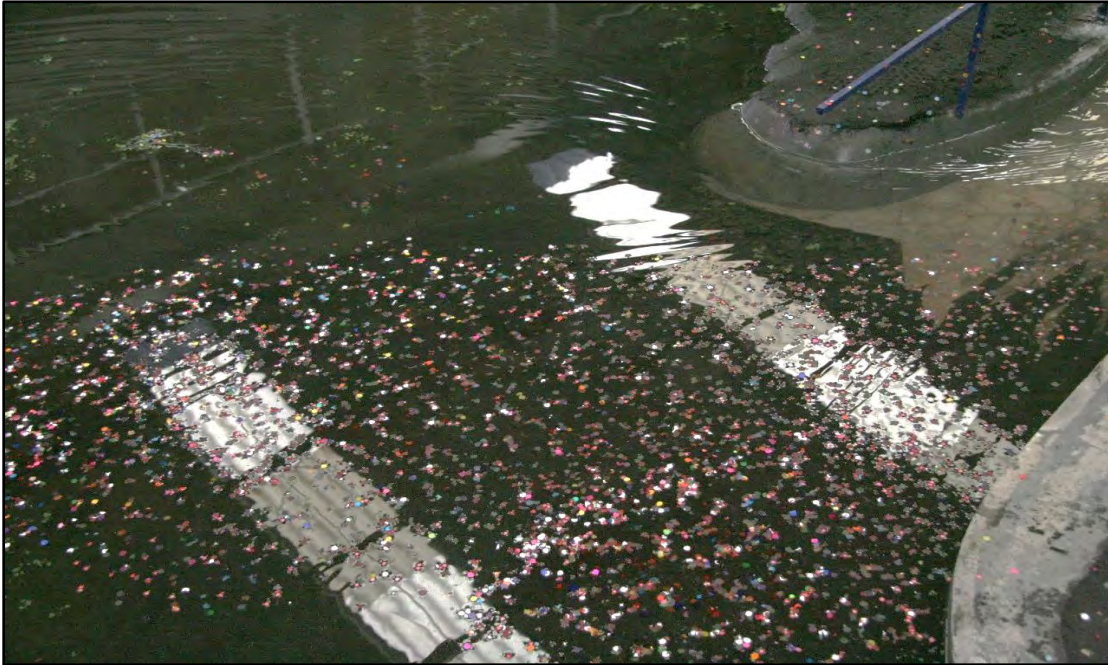
Figura 6.3. Líneas de corriente con depósito de sedimento #1
