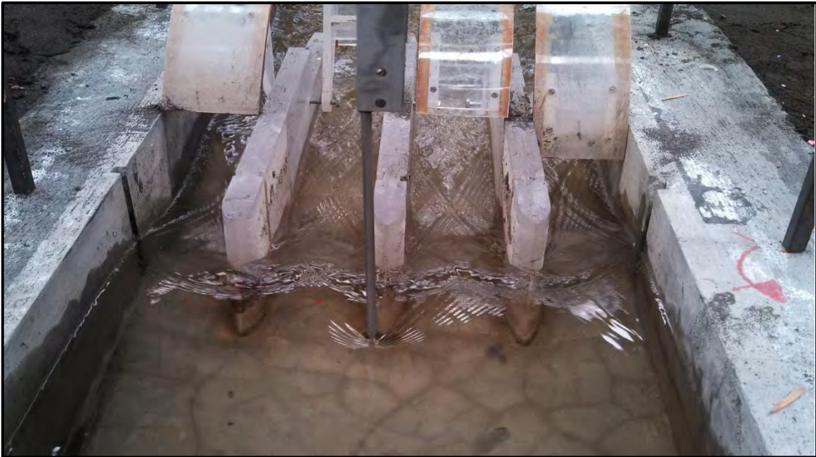
Figura 3.3. Pilas y compuertas radiales del Modelo Físico
