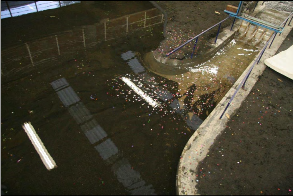
Figura 6.5. Líneas de corriente con depósito de sedimento #2
