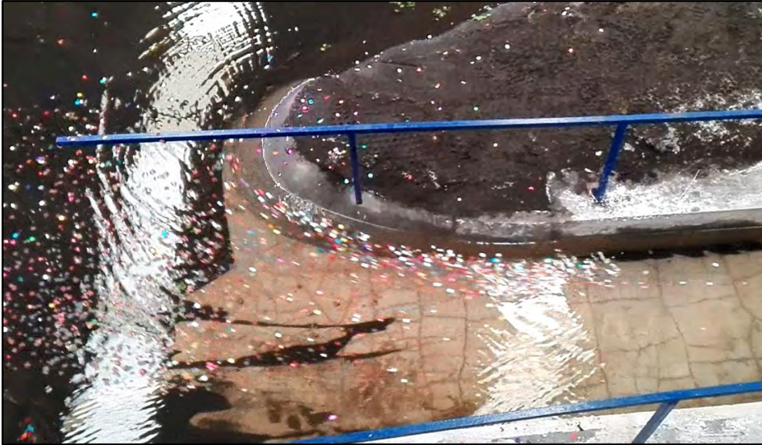
Figura 6.4. Líneas de corriente con depósito de sedimento #2
