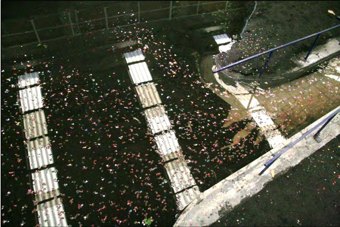
Figura 6.6. Líneas de corriente con depósito de sedimento #3
