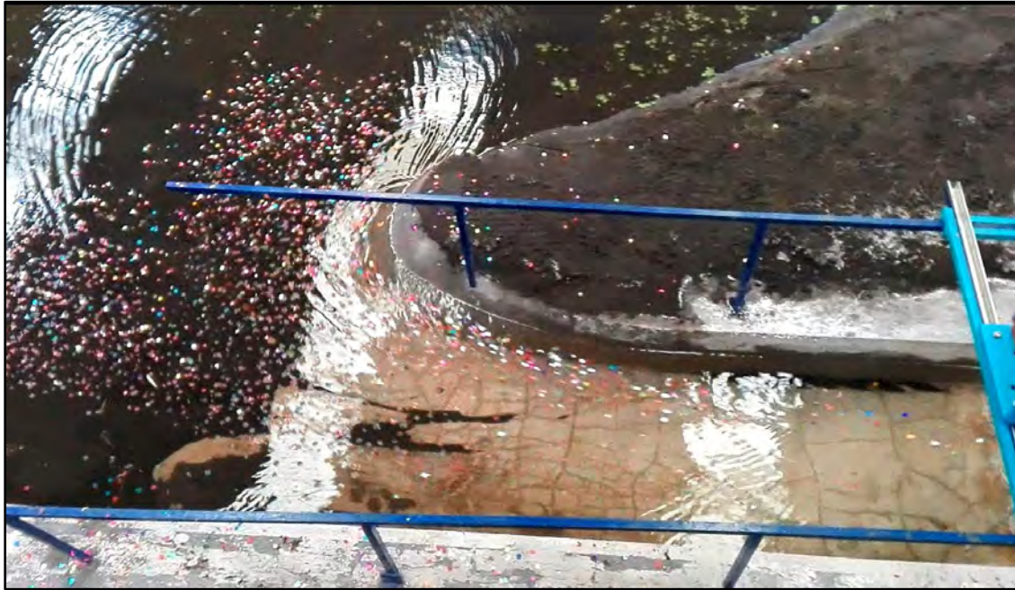
Figura 6.1. Líneas de corriente sin depósito de sedimento
