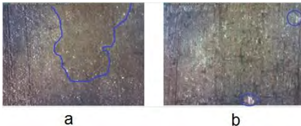
Figura 23. Imagen tomada con el estereoscopio de la probeta pátinada con gas oxiaetileno
