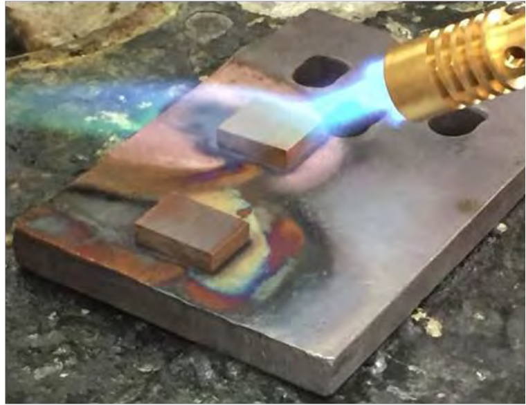
Figura 7. Probeta al ser calentada con gas propano
