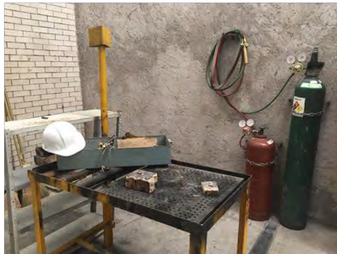
Figura 8. Equipo para soldadura autógena
