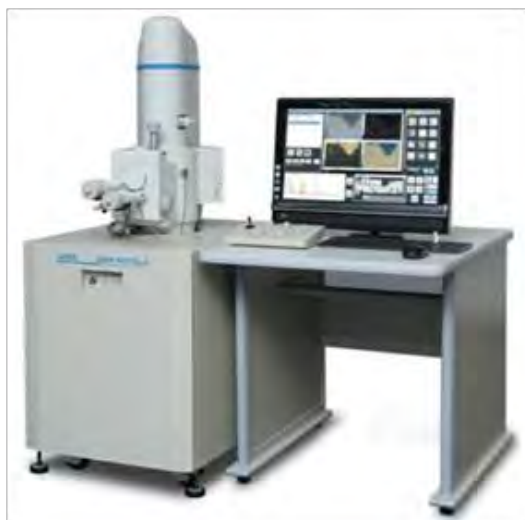
Figura 13. Microscopio electrónico de barrido utilizado
